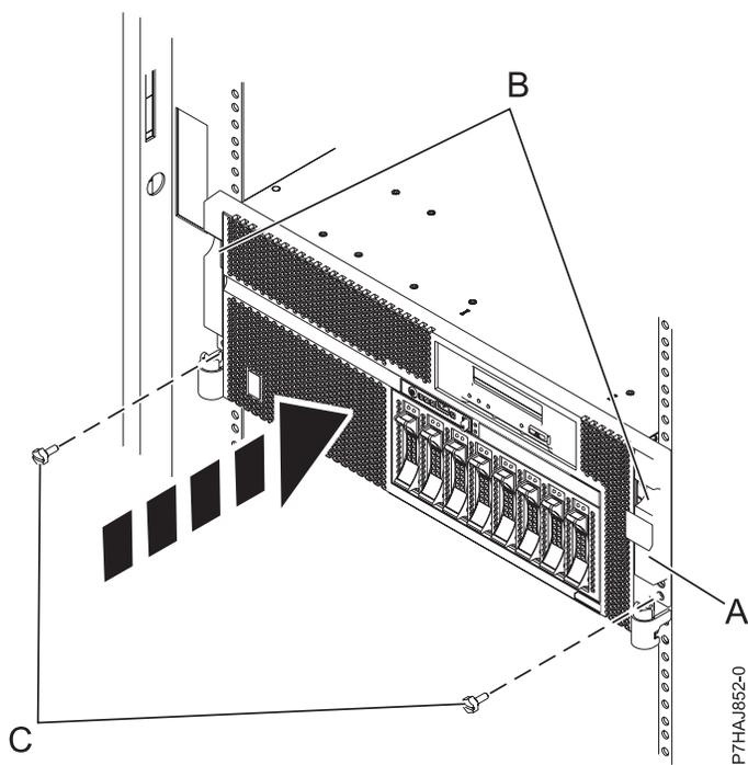
Figure 16. Remise en place des vis moletées
