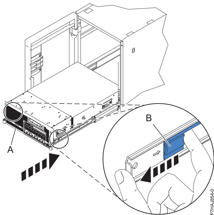
Figure 15. Déblocage des taquets de sécurité du rail
