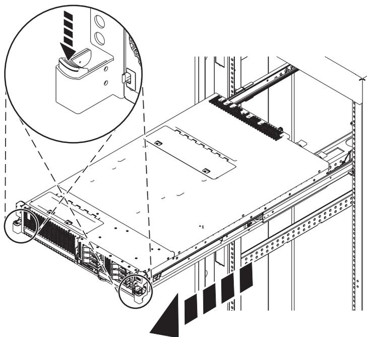
Figure 15. Placement du système en position de maintenance
