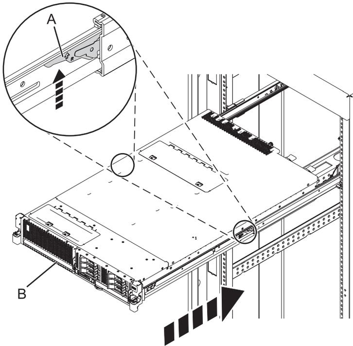
Figure 16. Déverrouillage des taquets de sécurité des glissières
