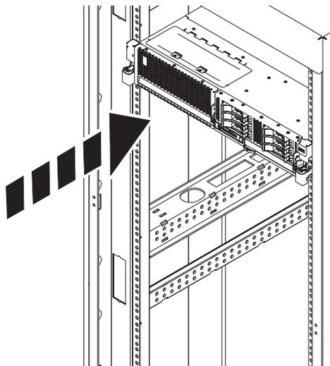
Figure 17. Mise en position de fonctionnement du système
