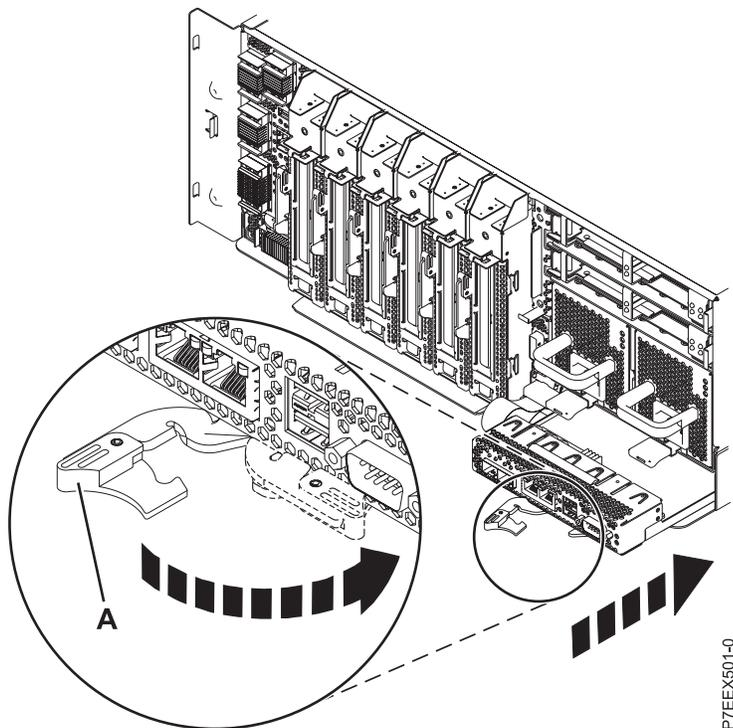
Figure 2. Installation de la carte multifonction intégrée dans un modèle monté en armoire pour le système 8248-L4T, 8408-E8D, ou 9109-RMD
