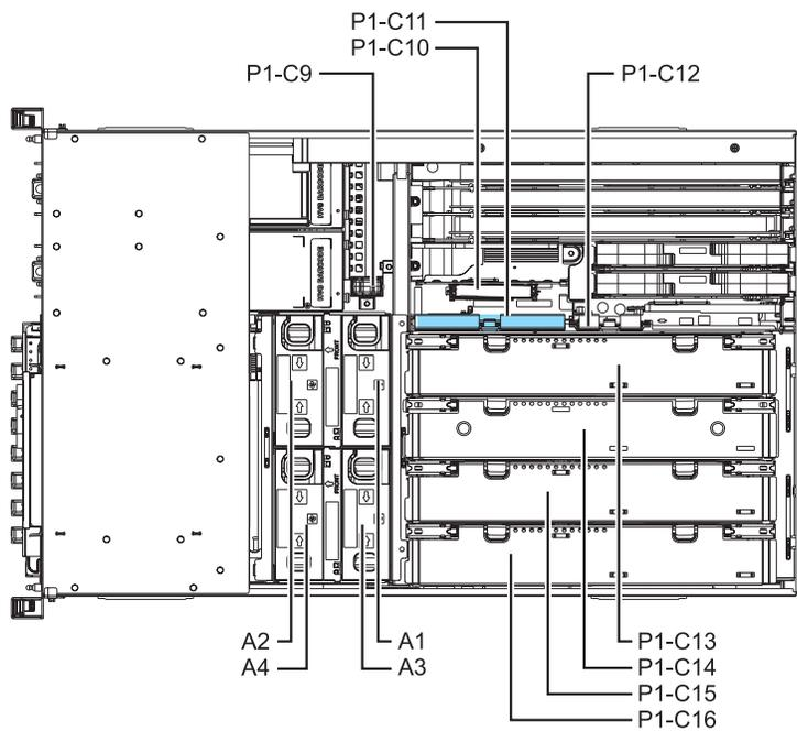
Figure 9. Emplacement d'installation de la carte d'activation RAID
