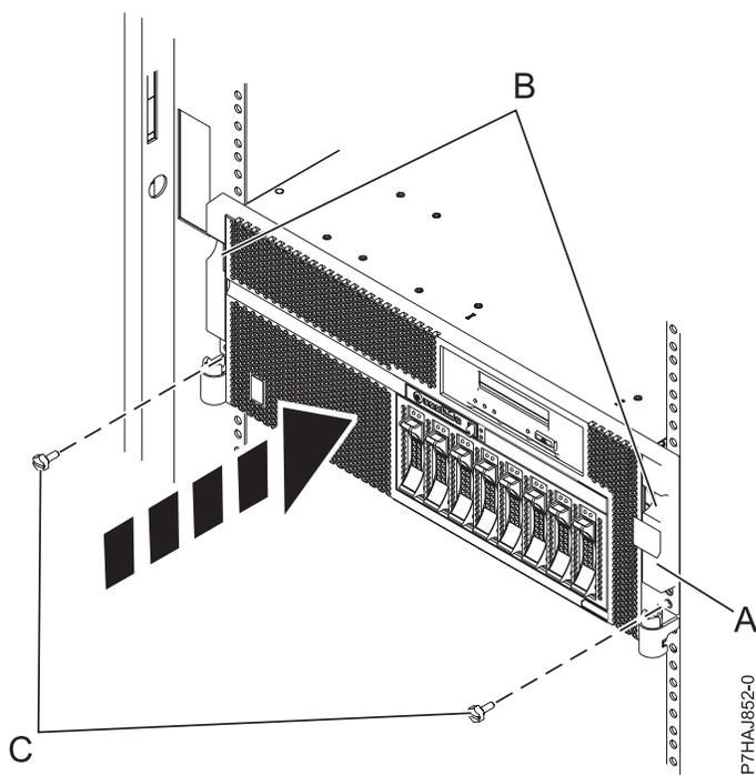
Figure 19. Remise en place des vis moletées
