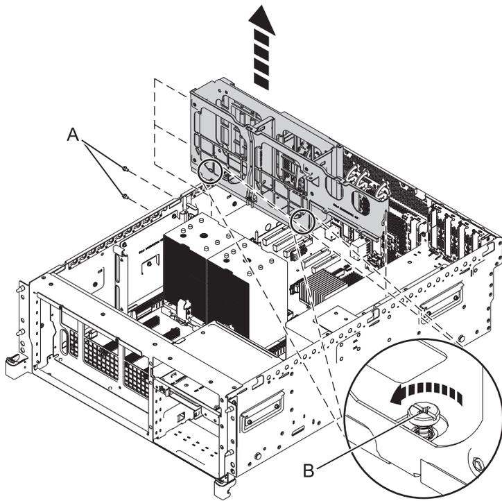
Figure 38. Retrait du boîtier du ventilateur intermédiaire
