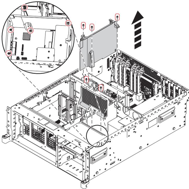
Figure 35. Retrait du boîtier d'unité de disque du système 8202-E4C, 8202-E4D, 8205-E6C ou 8205-E6D
