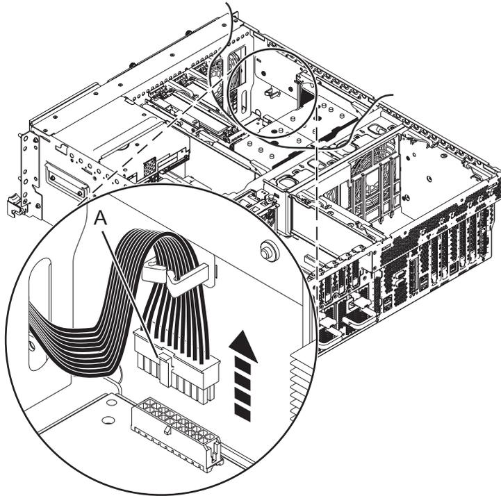
Figure 37. Retrait du câble du ventilateur avant
