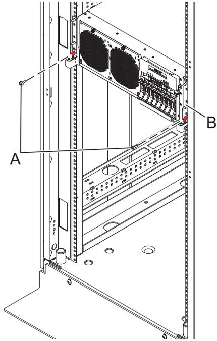
Figure 70. Mise en position de l'unité centrale
