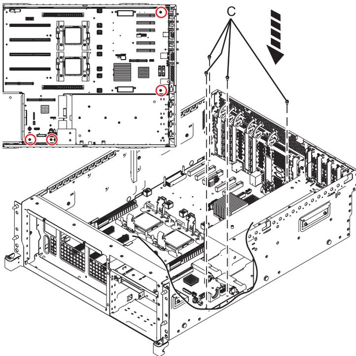
Figure 42. Installation du fond de panier système
