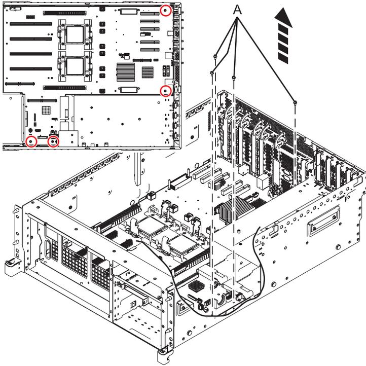
Figure 39. Retrait du fond de panier système du système 8202-E4B ou 8205-E6B
