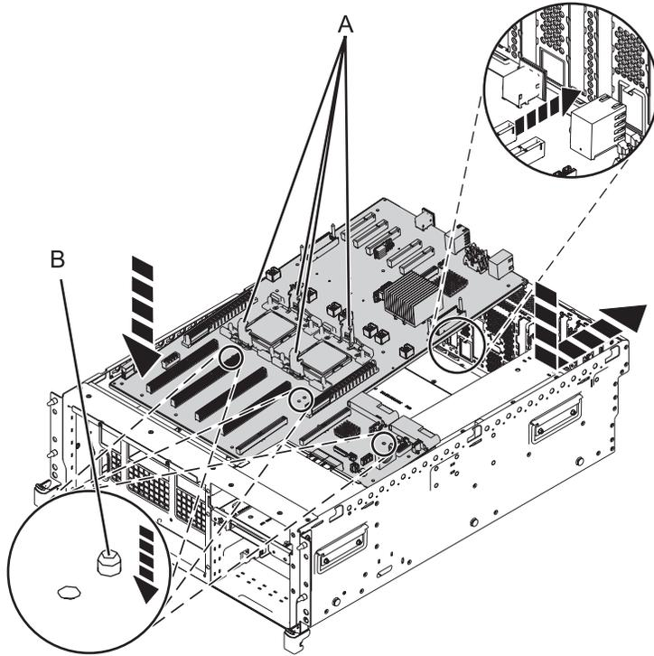
Figure 41. Installation du fond de panier système sur le serveur 8202-E4B ou 8205-E6B
