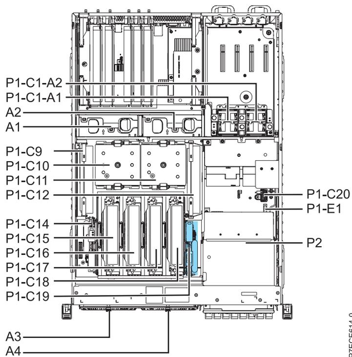
Figure 3. Emplacements de contrôleur de stockage RAID-10 (P1-C19) pour le système 8202-E4C, 8202-E4D, 8205-E6C ou 8205-E6D
