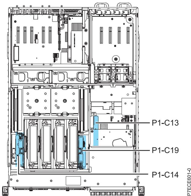
Figure 10. Emplacement de la carte d'activation RAID (P1-C13)
