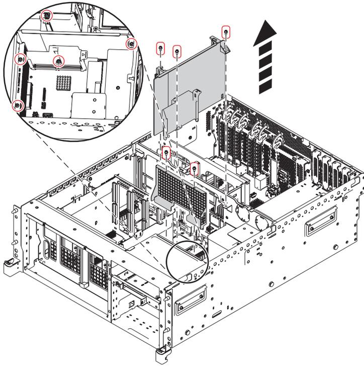
Figure 34. Retrait du boîtier d'unité de disque du système 8202-E4B ou 8205-E6B
