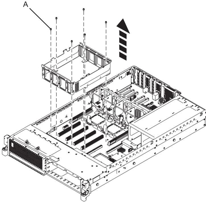
Figure 32. Retrait du boîtier de barrette DIMM
