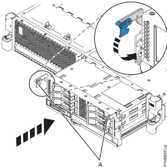
Figure 23. Installation d'un fond de panier doté d'unités de disque dans un modèle monté en armoire
