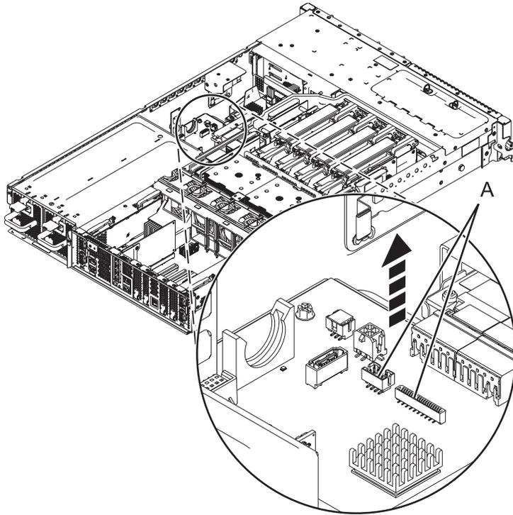
Figure 27. Débranchement du câble du panneau de commande
