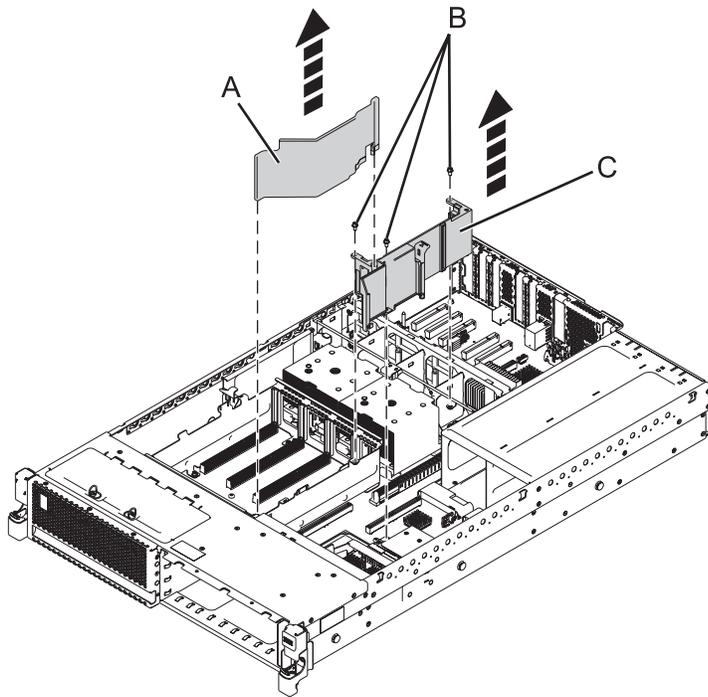
Figure 31. Retrait du guide et du diviseur d'air du régulateur de tension
