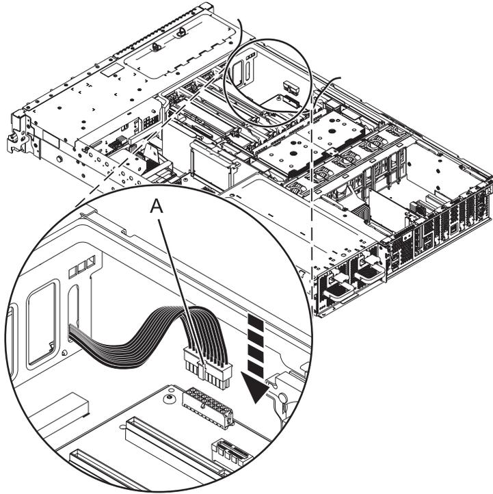
Figure 38. Connexion du câble du ventilateur
