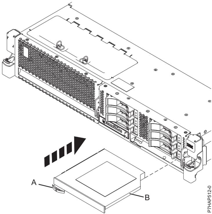
Figure 26. Installation de l'unité de stockage extra-plate
