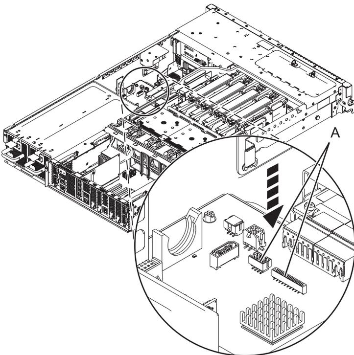
Figure 44. Connexion du câble du panneau de commande
