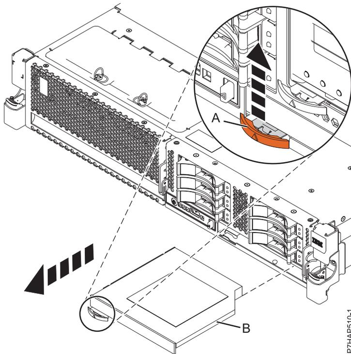
Figure 18. Retrait de l'unité de stockage extra-plate du fond de panier d'unité de disque
