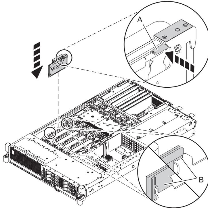
Figure 3. Remise en place de la carte de piles de cache pour 8246-L1C, 8246-L1D, 8246-L1S, 8246-L1T, 8246-L2C, 8246-L2D, 8246-L2S ou 8246-L2T
