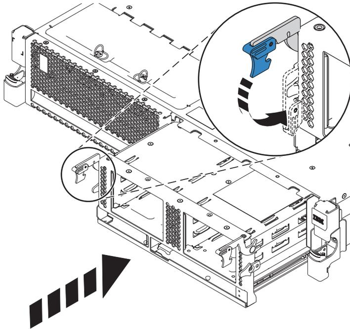
Figure 41. Remise en place du boîtier de l'unité de disque
