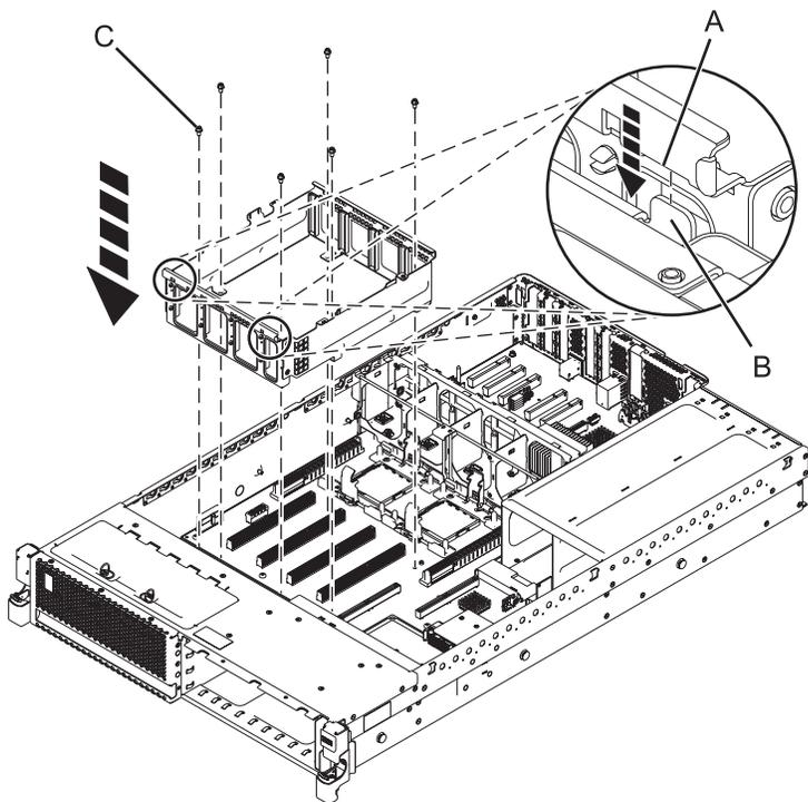
Figure 39. Remise en place du boîtier de barrette DIMM
