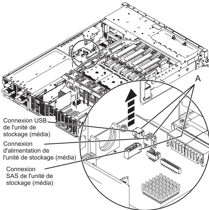
Figure 29. Débranchement des câbles de l'unité de stockage (média)
