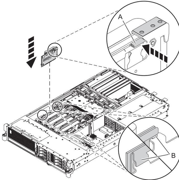
Figure 12. Installation de la carte de piles de cache sur le système 8246-L1C, 8246-L1D, 8246-L1S, 8246-L1T, 8246-L2C, 8246-L2D, 8246-L2S ou 8246-L2T
