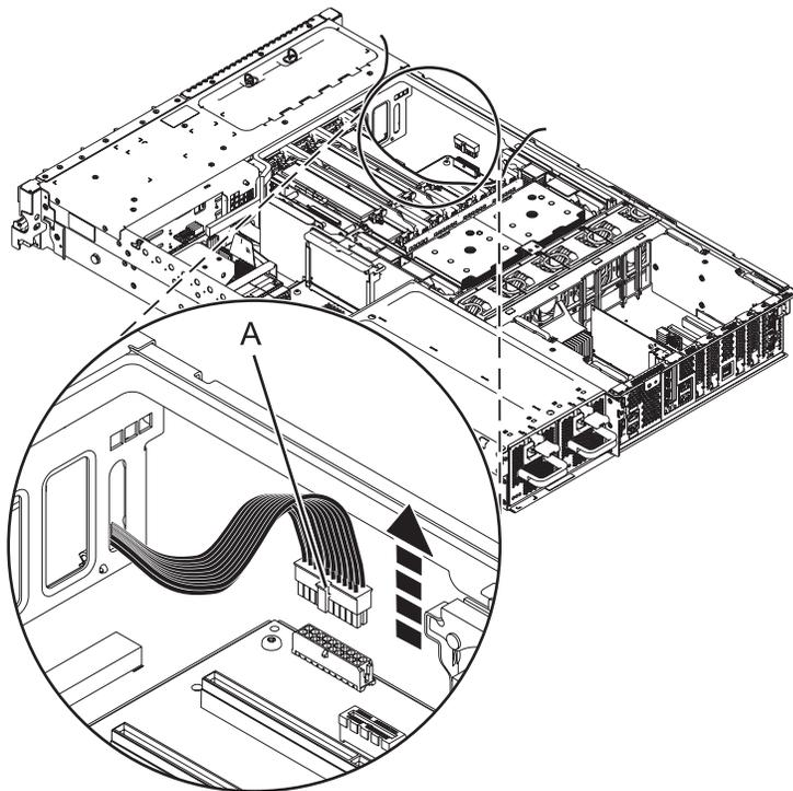
Figure 33. Retrait du câble du ventilateur avant
