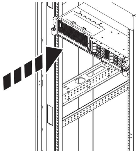
Figure 53. Placement du système en position de fonctionnement
