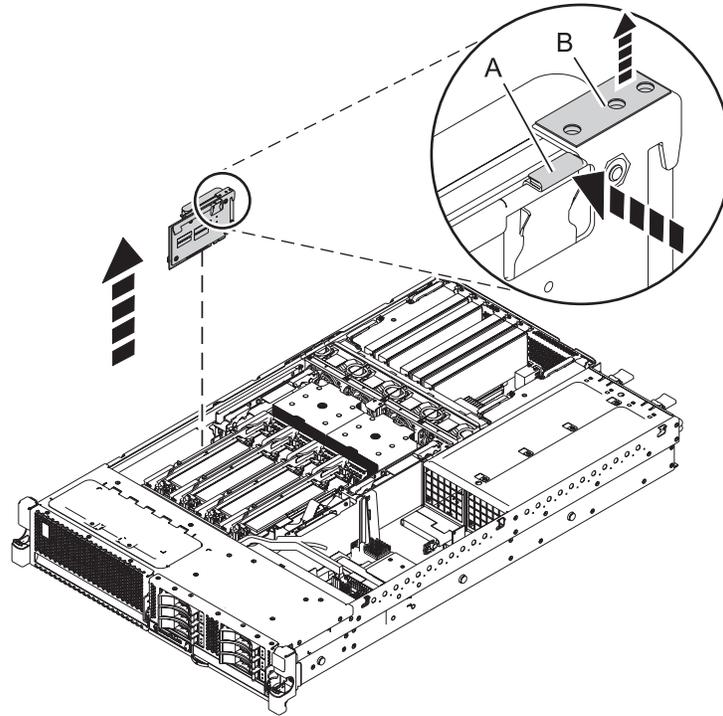
Figure 11. Retrait de la carte de piles de cache du système 8246-L1C, 8246-L1D, 8246-L1S, 8246-L1T, 8246-L2C, 8246-L2D, 8246-L2S ou 8246-L2T
