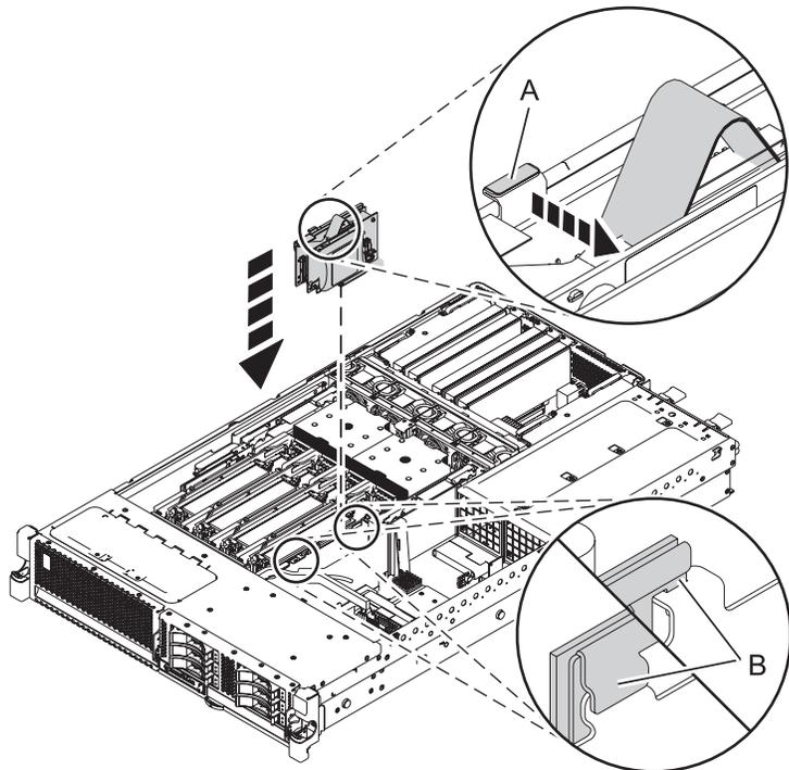
Figure 9. Remise en place d'un contrôleur de stockage RAID/cache dans un système 8246-L1C, 8246-L1D, 8246-L1S, 8246-L1T, 8246-L2C, 8246-L2D, 8246-L2S ou 8246-L2T
