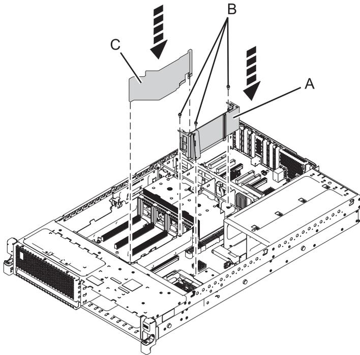
Figure 40. Remplacement du répartiteur d'air du régulateur de tension
