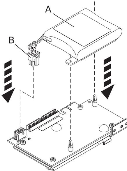
Figure 14. Remplacement de la batterie de cache
