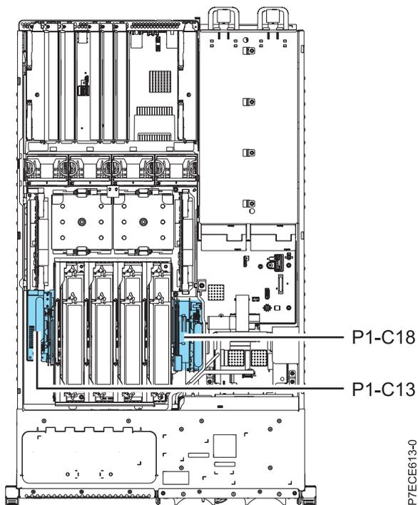
Figure 1. Emplacement d'installation du contrôleur de stockage et de la carte de piles de cache pour 8246-L1C, 8246-L1D, 8246-L1S, 8246-L1T, 8246-L2C, 8246-L2D, 8246-L2S ou 8246-L2T
