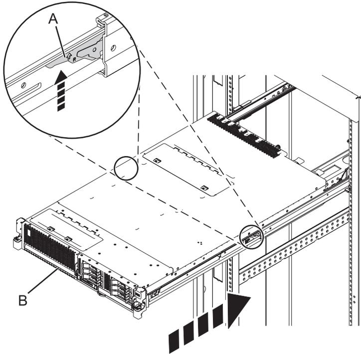
Figure 52. Déverrouillage des taquets de sécurité des glissières
