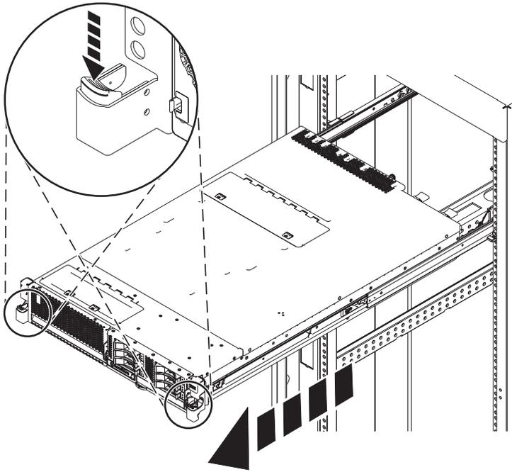
Figure 51. Placement du système en position de maintenance
