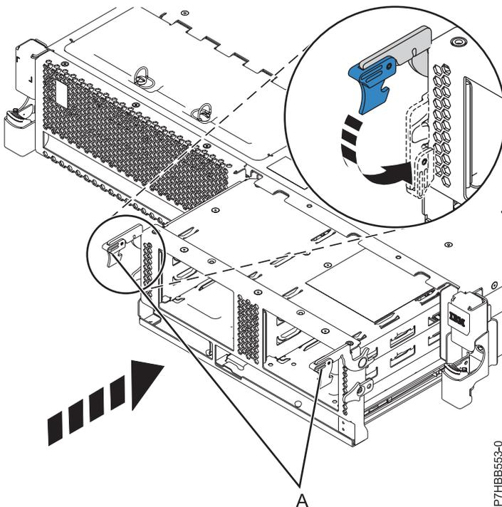
Figure 22. Installation d'un fond de panier sans unités de disque dans un modèle monté en armoire
