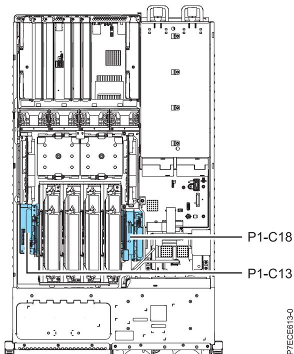
Figure 7. Emplacement d'installation du contrôleur de stockage (P1-C18) et de la carte de piles de cache (P1-C13) sur le système 8246-L1C, 8246-L1D, 8246-L1S, 8246-L1T, 8246-L2C, 8246-L2D, 8246-L2S ou 8246-L2T
