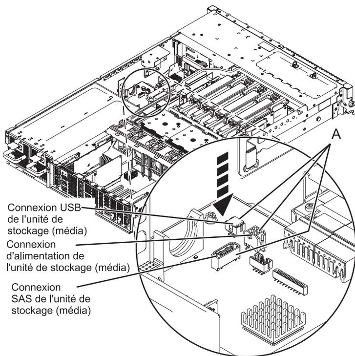
Figure 42. Connexion des câbles de l'unité de stockage
