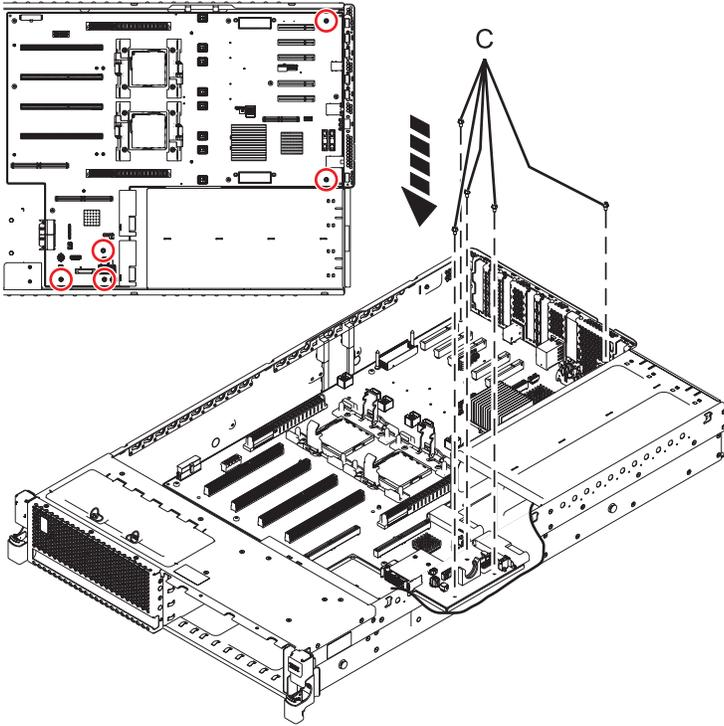
Figure 37. Remplacement du fond de panier système )
