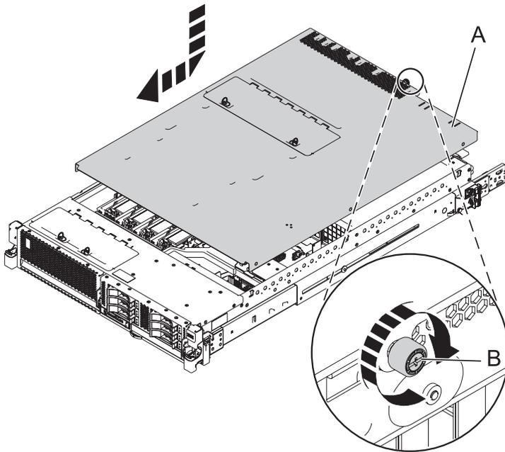
Figure 50. Installation du capot d'accès
