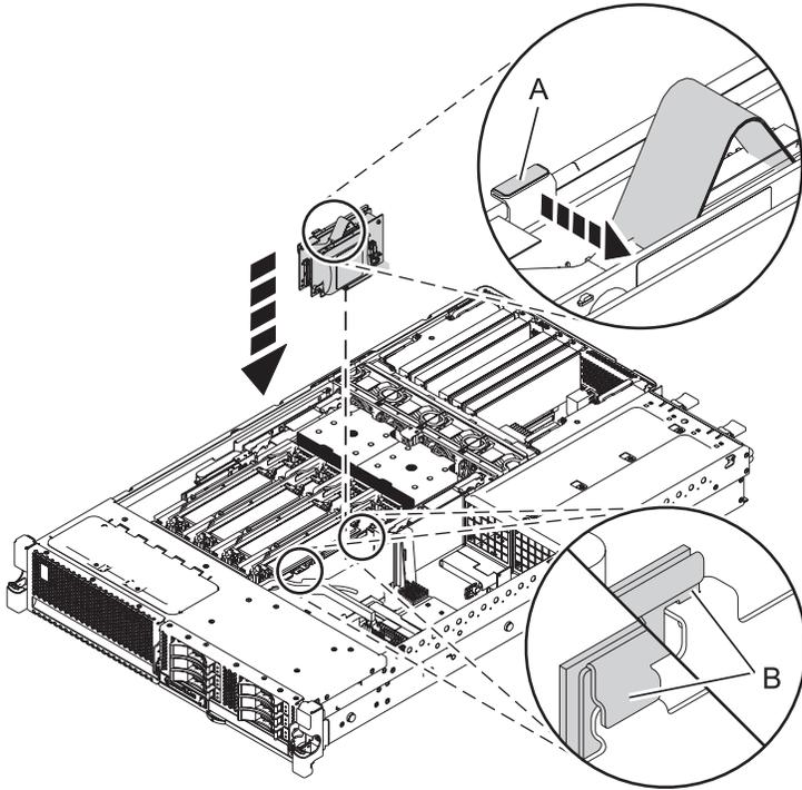
Figure 2. Remplacement d'un contrôleur de stockage RAID/cache sur un système 8246-L1C, 8246-L1D, 8246-L1S, 8246-L1T, 8246-L2C, 8246-L2D, 8246-L2S ou 8246-L2T monté en armoire
