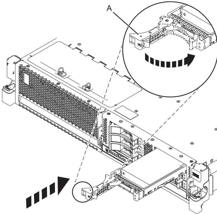
Figure 24. Installation des unités de disque du fond de panier
