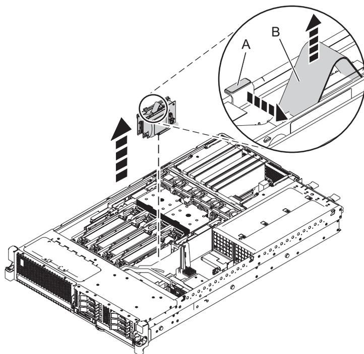
Figure 8. Retrait d'un contrôleur de stockage RAID/cache d'un système 8246-L1C, 8246-L1D, 8246-L1S, 8246-L1T, 8246-L2C, 8246-L2D, 8246-L2S ou 8246-L2T monté en armoire
