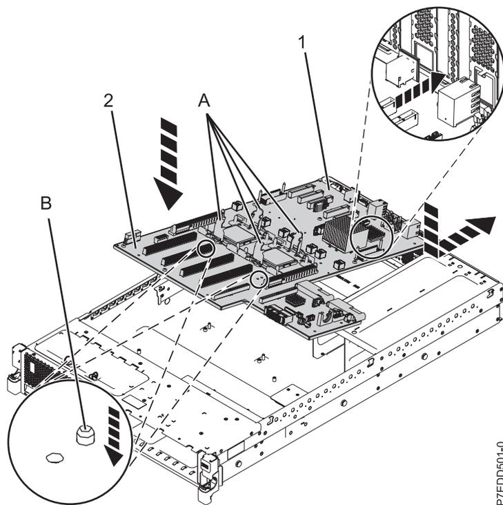
Figure 36. Remplacement du fond de panier système
