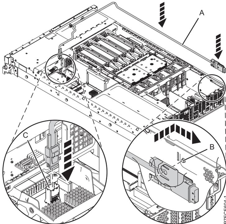
Figure 6. Installation du câble d'E-S SAS
