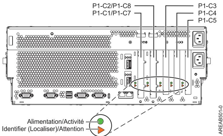
Figure 1. Vue arrière du système avec codes d'emplacement. Le tableau 4, à la page 15 présente la vue arrière du système avec les codes d'emplacement pour les emplacements de carte PCI ou d'adaptateur GX.
