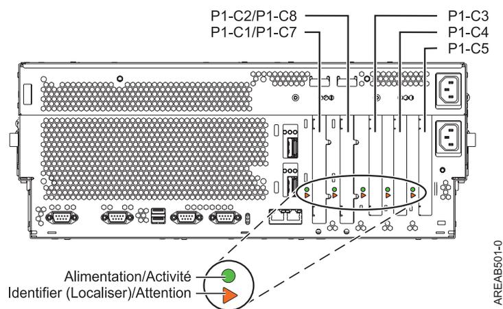
Figure 2. Vue arrière du boîtier avec codes d'emplacement. Le tableau 11 présente la vue arrière de l'unité centrale, avec les codes d'emplacement PCI et GX+.
