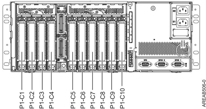
Figure 4. Vue arrière. La figure suivante illustre la vue arrière de l'unité d'extension.
