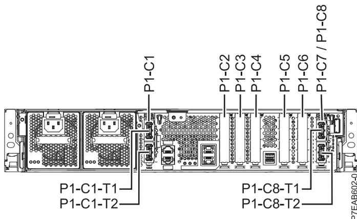
Figure 2. Vue arrière du système avec codes d'emplacement
