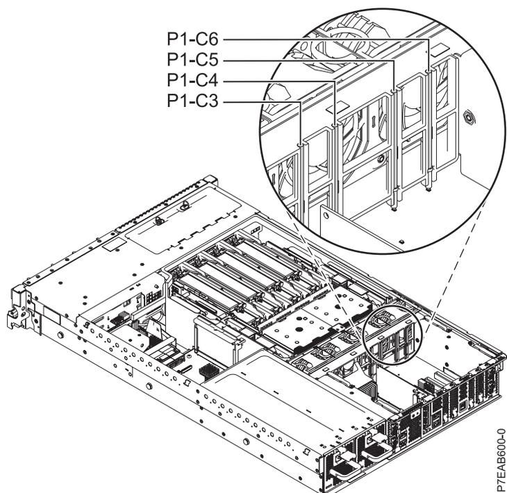
Figure 1. Vue arrière du 8231-E2B avec codes d'emplacement PCI
