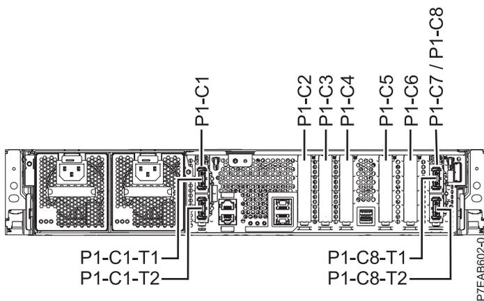
Figure 3. Vue arrière du système avec codes d'emplacement
