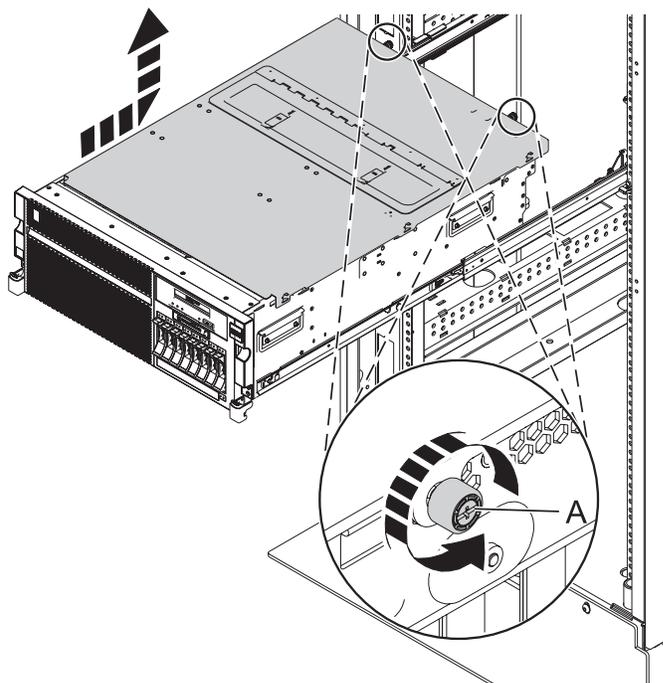
Figura 17. Extraer la cubierta de acceso de servicio
