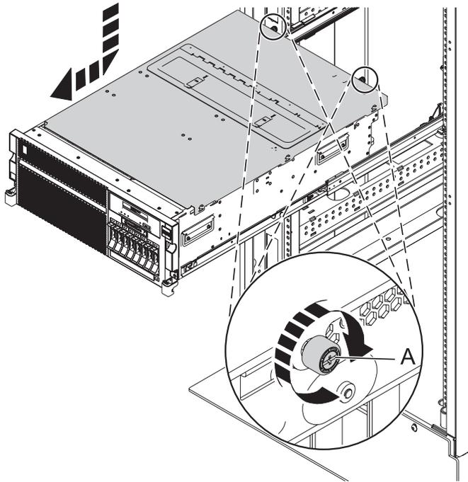
Figura 20. Instalar la cubierta de acceso de servicio
