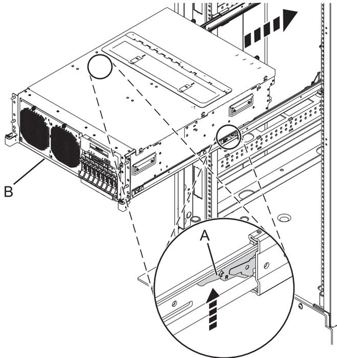
Figura 25. Colocar el sistema en la posición operativa
