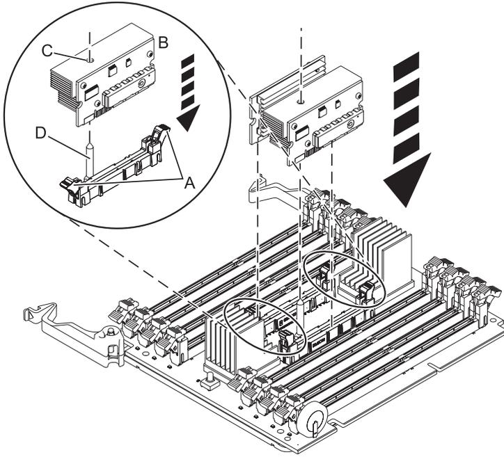
Figura 3. Módulo regulador de voltaje de memoria sobre los conectores del conjunto de DIMM de memoria
