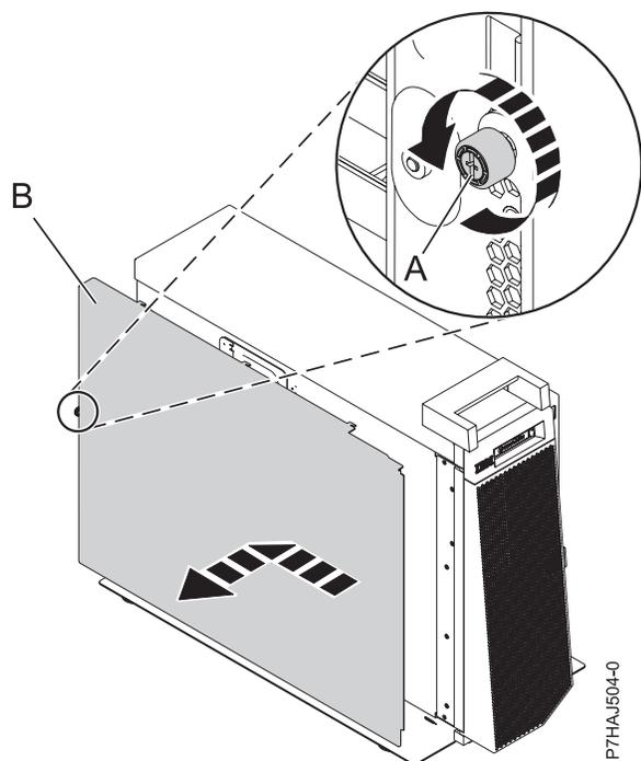
Figura 18. Instalar la cubierta de acceso de servicio exterior
