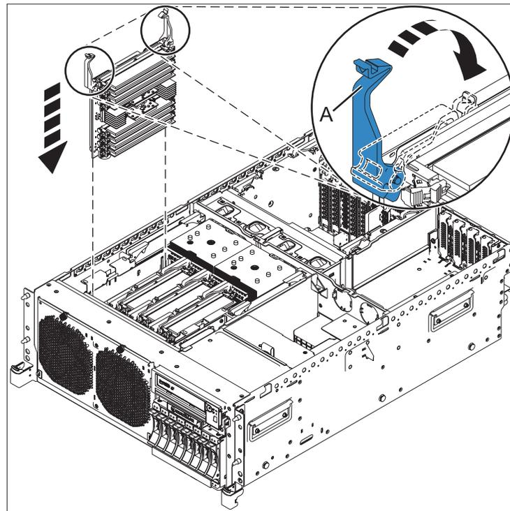
Figura 7. Extracción de una tarjeta de expansión de módulo de memoria
