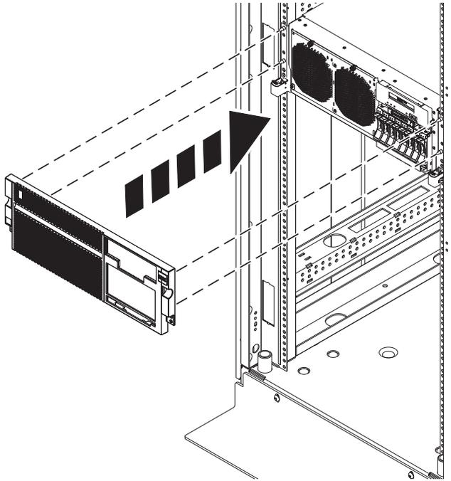
Figura 14. Extracción de la cubierta frontal
