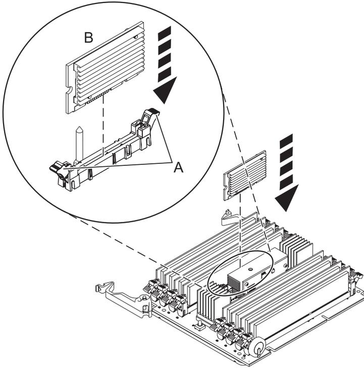
Figura 8. Instalación del módulo regulador de voltaje de memoria
