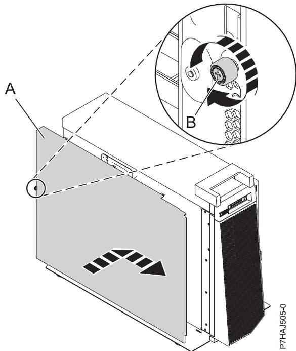
Figura 22. Instalar la cubierta de acceso de servicio exterior
