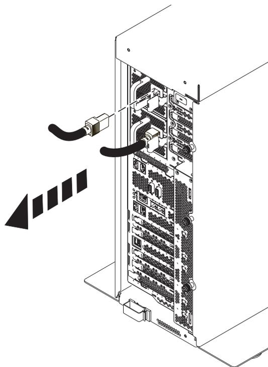
Figura 28. Quitar los cables de alimentación para un sistema autónomo
