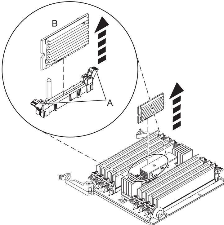
Figura 6. Extracción del módulo regulador de voltaje de memoria
