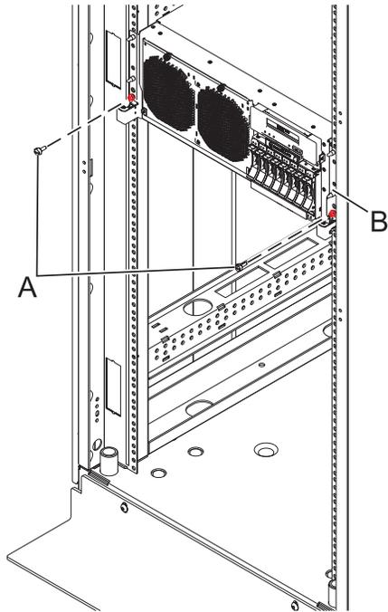
Figura 23. Colocar la unidad del sistema en la posición de servicio
