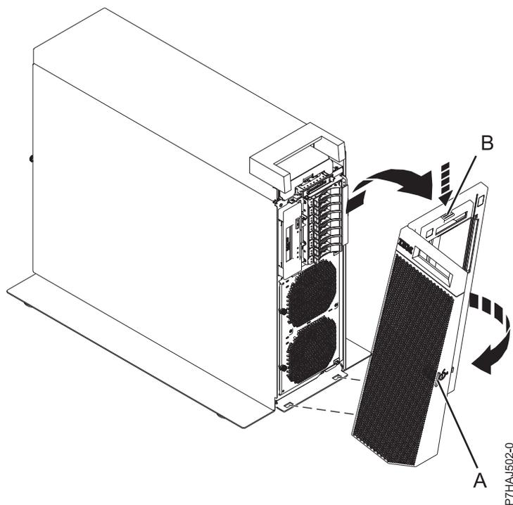
Figura 13. Extraer la cubierta frontal
