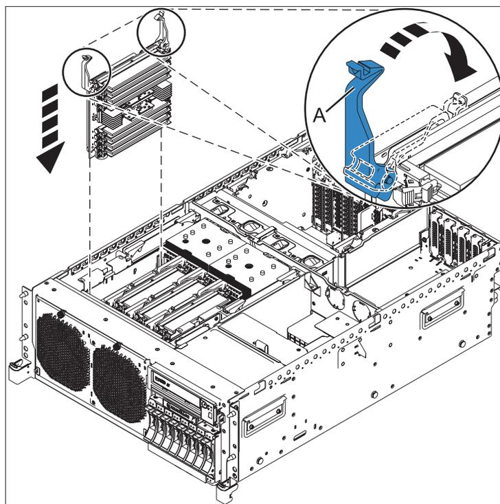
Figura 9. Sustitución de un módulo de expansión de memoria
