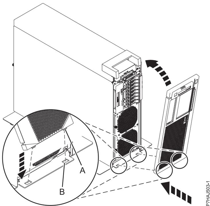
Figura 15. Instalar la cubierta frontal
