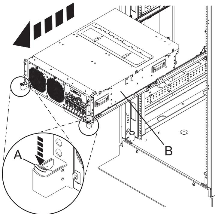
Figura 24. Bloquear la unidad del sistema en la posición de servicio
