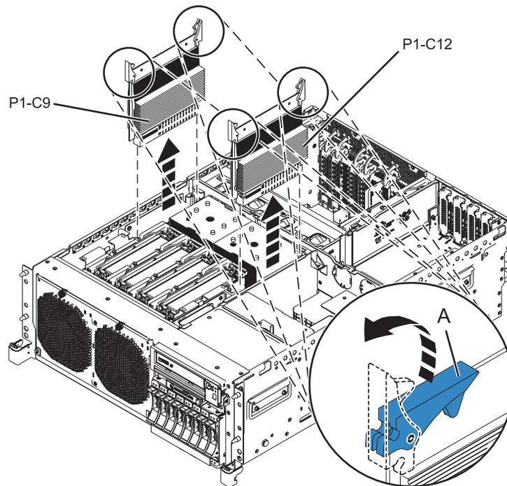
11. Coloque el módulo regulador de voltaje sobre una superficie de descarga electrostática (ESD).
