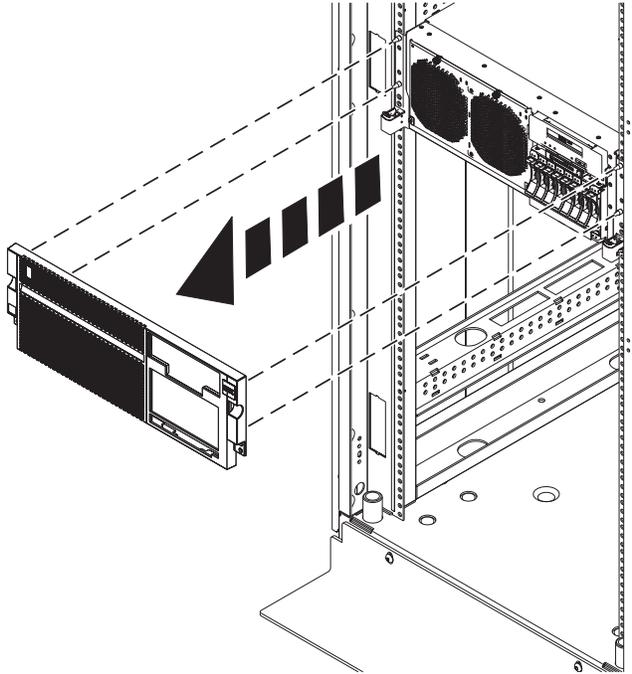
Figura 12. Extracción de la cubierta frontal
