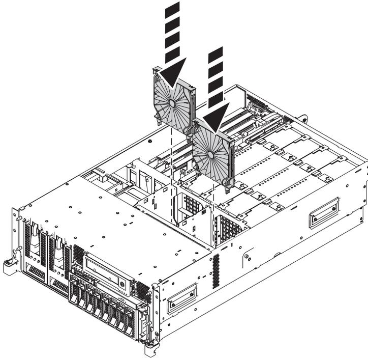
Vuelva a poner los ventiladores insertándolos en el chasis de ventilador hasta que queden fijados en su sitio, como se muestra en la figura siguiente.
