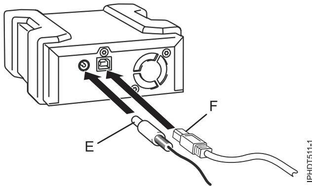
3. Conecte el otro extremo del cable USB externo (F) a un puerto USB integrado externo o a los puertos USB de un adaptador USB de cuatro puertos PCI Express (código de característica 2728).
