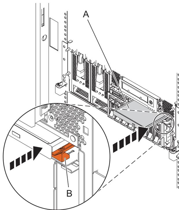
*Figura 7. Instalar un dispositivo de soporte extraplano*
