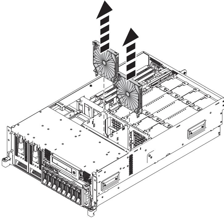
Figura 9. Extracción de deflectores de aire
