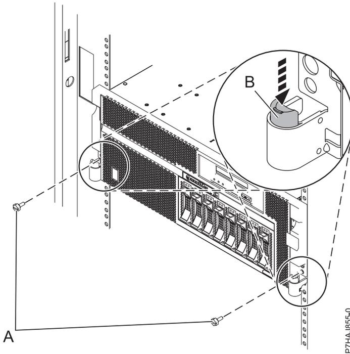
Figura 23. Soltar los pestillos del bastidor
