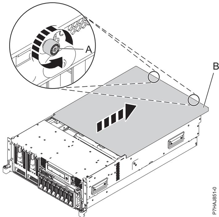
Figura 21. Extraer la cubierta de acceso de servicio
