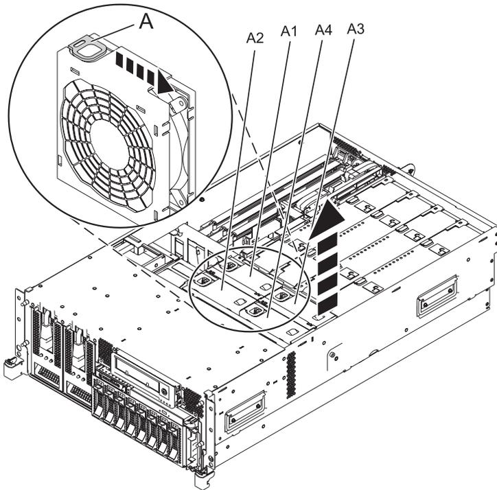
Figura 4. Extracción del ventilador
