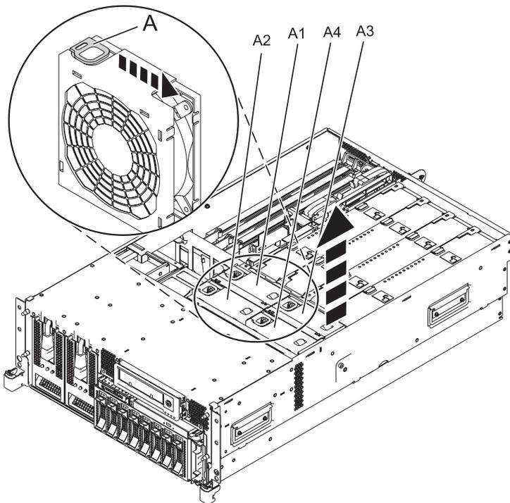
Figura 13. Extracción del ventilador
