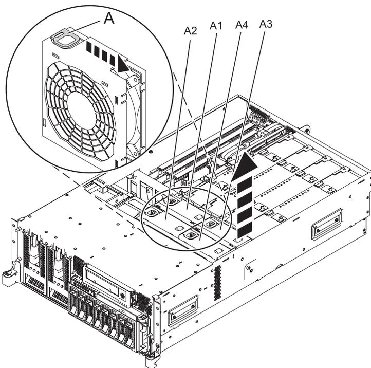
Figura 8. Extracción del ventilador
