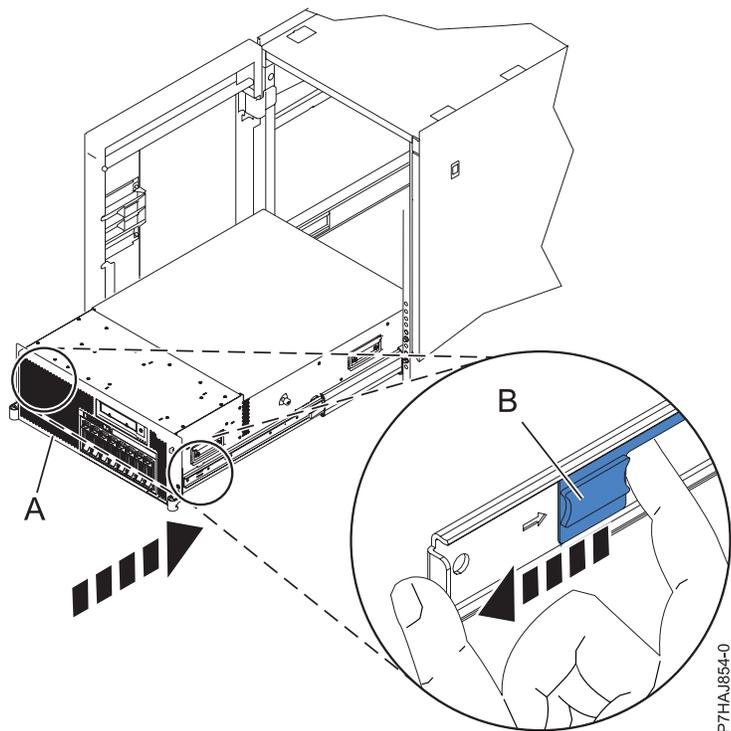
Figura 24. Soltar los pestillos de seguridad de los rieles
