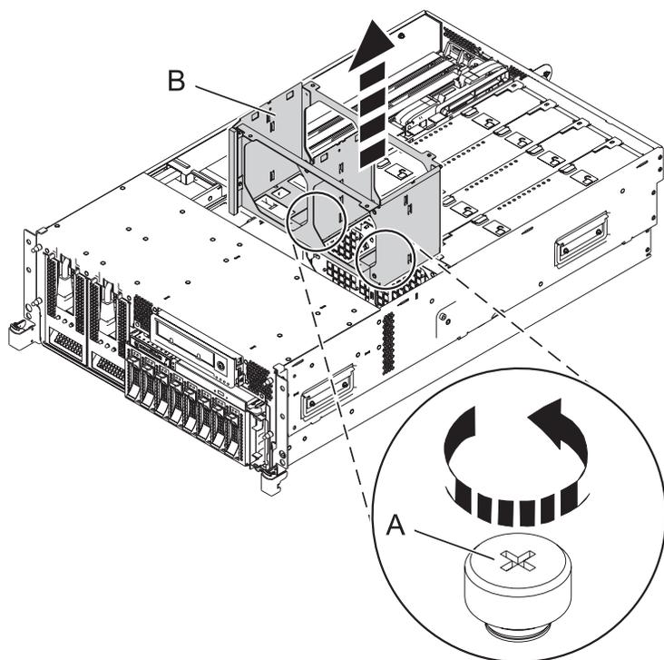
Figura 12. Extracción del chasis de ventilador
