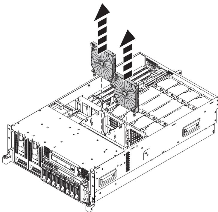
Figura 11. Extracción de deflectores de aire
