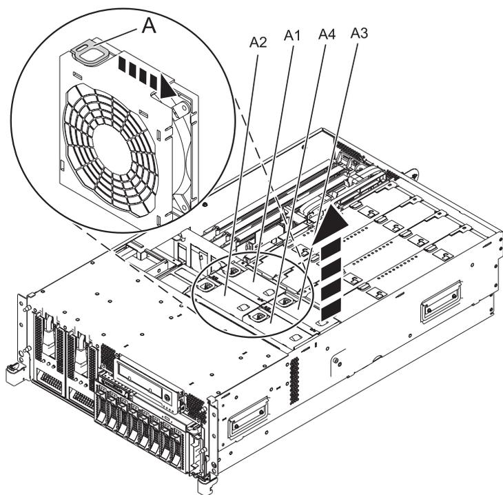
Figura 10. Extracción del ventilador
