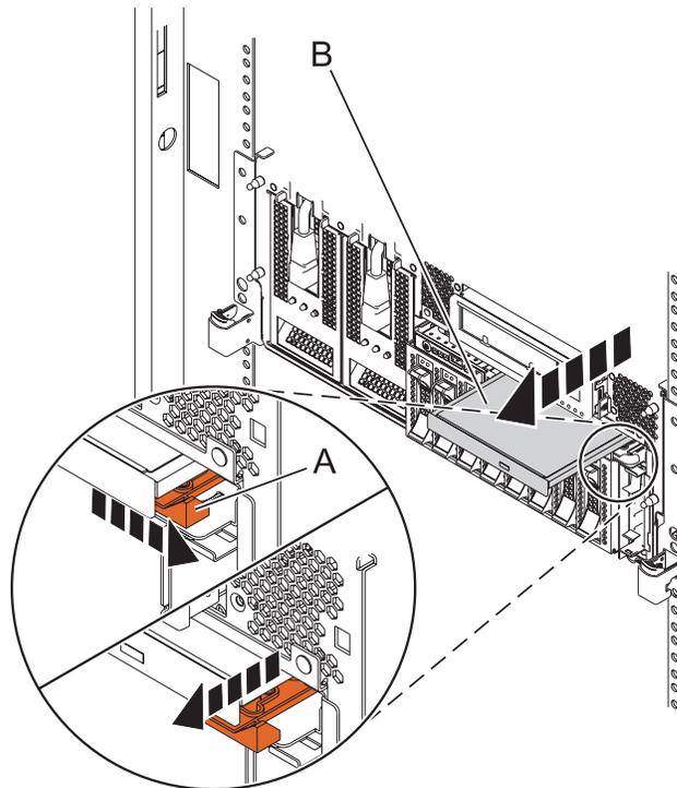
4. Tire del dispositivo de soporte extraplano (**B**) para extraerlo del sistema.
