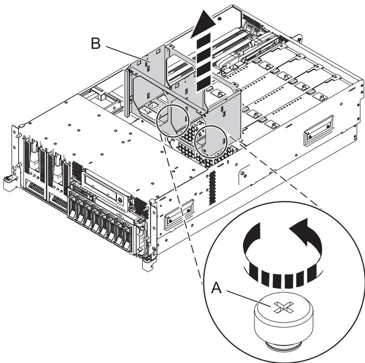
Figura 15. Extracción del chasis de ventilador
