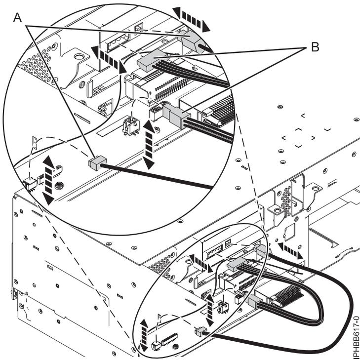
Figura 16. Conexión de las conexiones del dispositivo de soporte a la placa posterior de un sistema 8233-E8B o 8236-E8C
