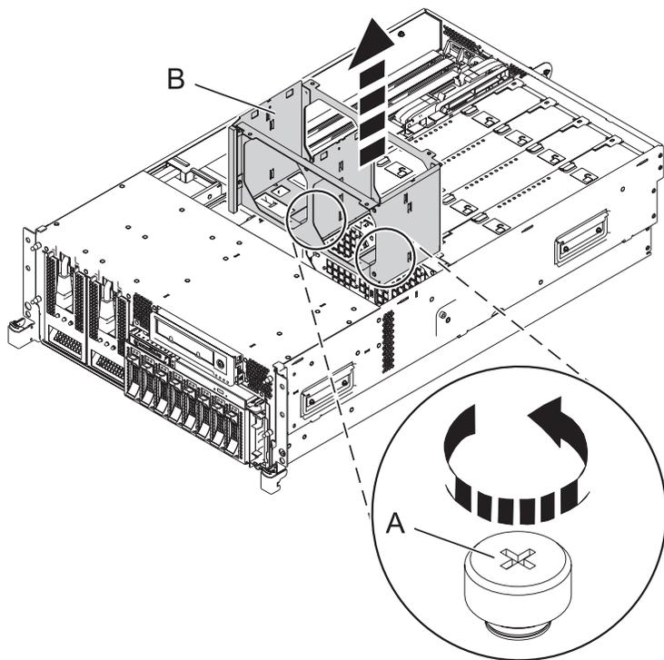
Figura 6. Extracción del chasis de ventilador
