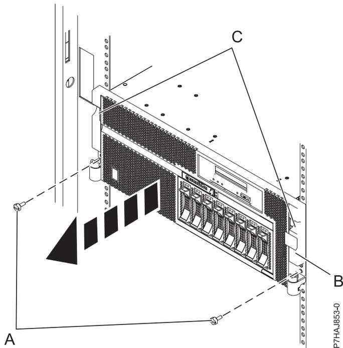
Figura 19. Extraer la cubierta frontal
