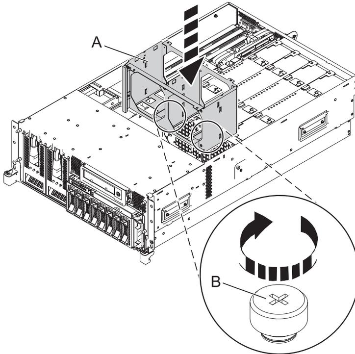
b. Sustituir los deflectores de aire azules como se muestra en la figura siguiente.
