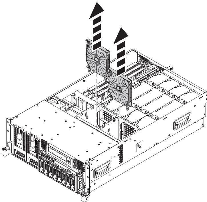
Figura 2. Extracción de deflectores de aire
