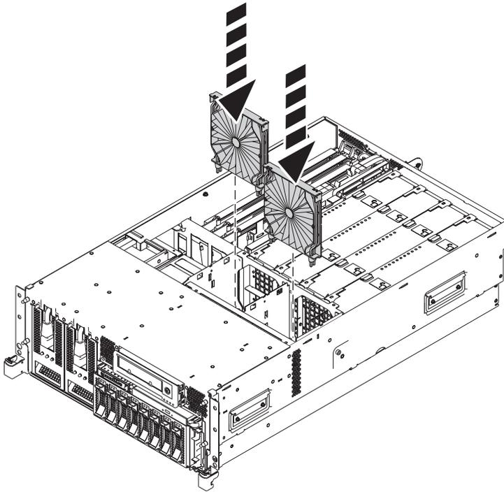
Vuelva a poner los ventiladores insertándolos en el chasis de ventilador hasta que queden fijados en su sitio, como se muestra en la figura siguiente.
