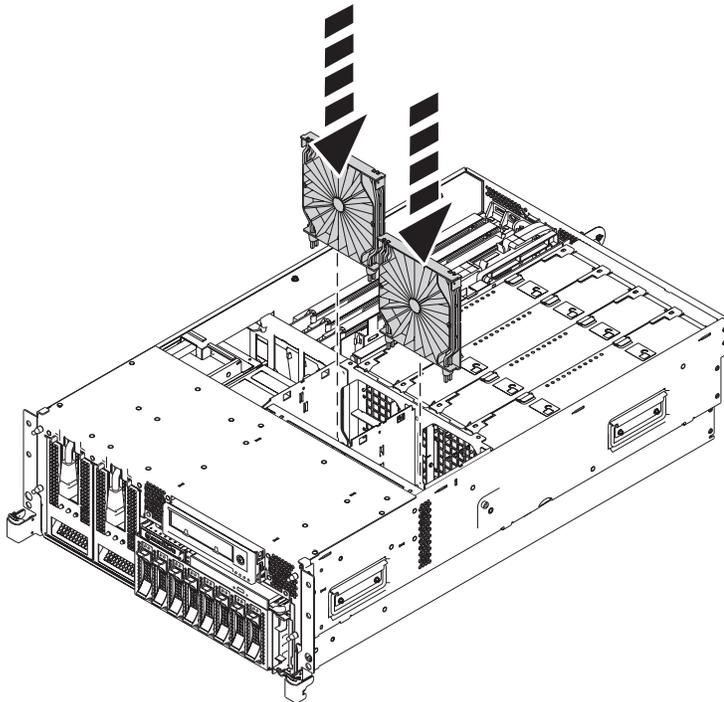
c. Vuelva a poner los ventiladores insertándolos en el chasis de ventilador hasta que queden fijados en su sitio, como se muestra en la figura siguiente.
