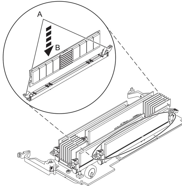
*Figura 11. Sustitución de un módulo de memoria*
