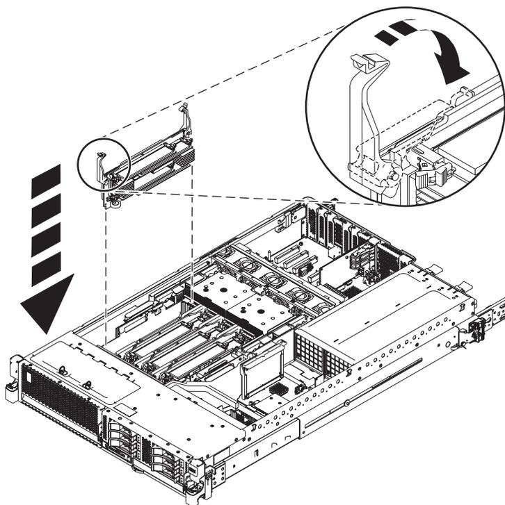
*Figura 3. Sustitución de una tarjeta de memoria*
