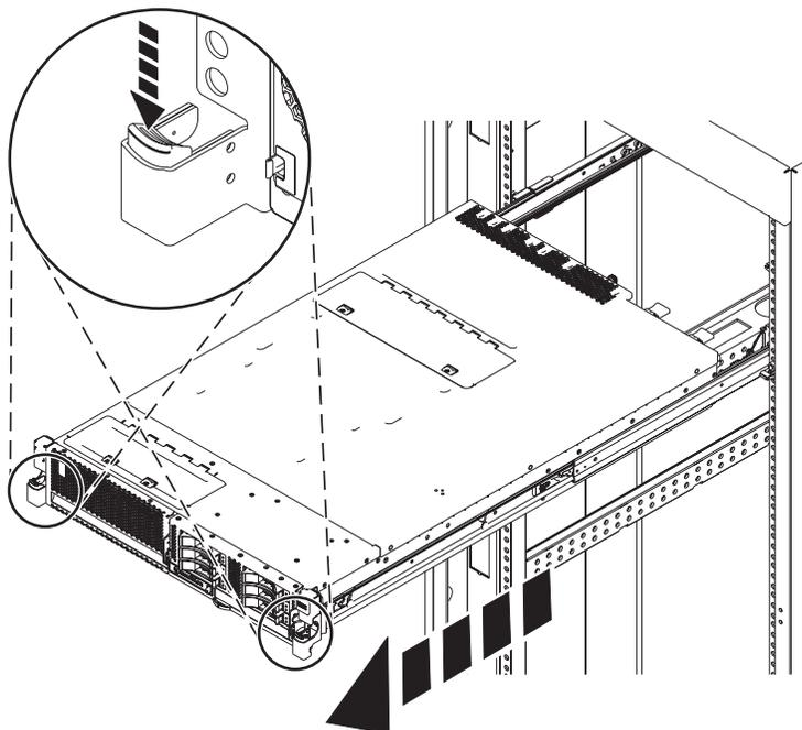
Figura 17. Colocación del sistema en posición de servicio
