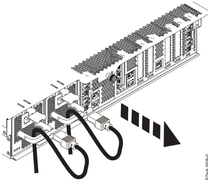
Figura 20. Extracción de los cables de alimentación
