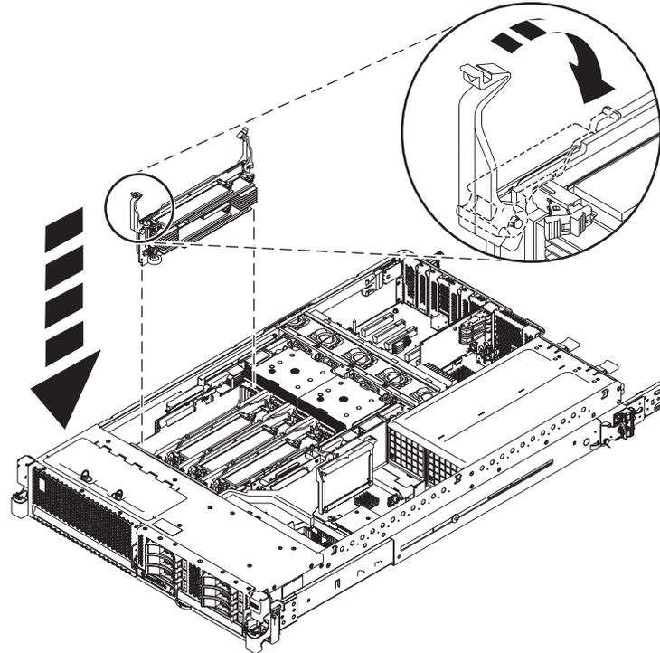
Figura 1. Instalación de una tarjeta de memoria
