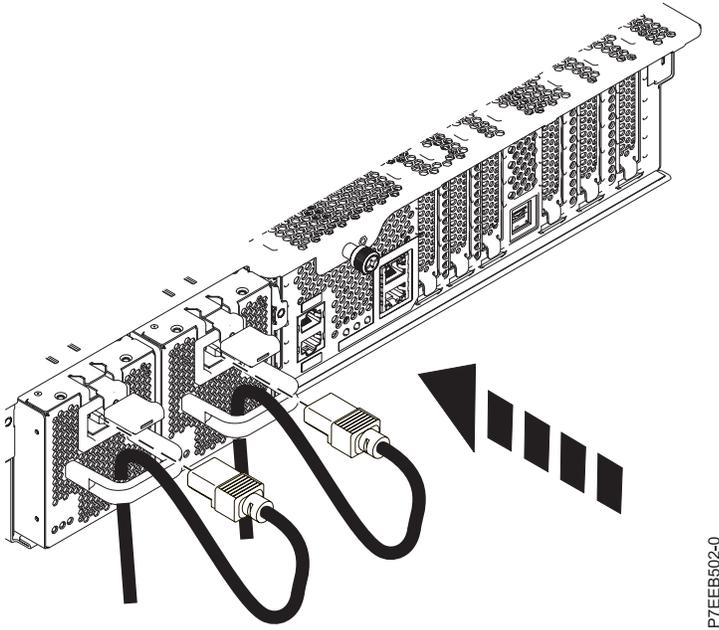
Figura 21. Recorrido y conexión del cable de alimentación
