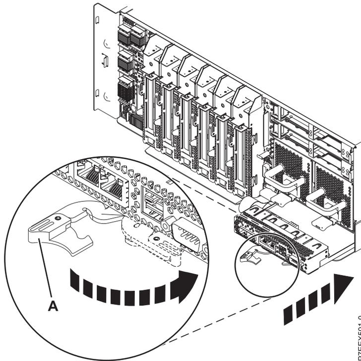
Figura 2. Instalación de la tarjeta multifunción integrada en un modelo montado en bastidor para el sistema 8248-L4T, 8408-E8D o 9109-RMD
