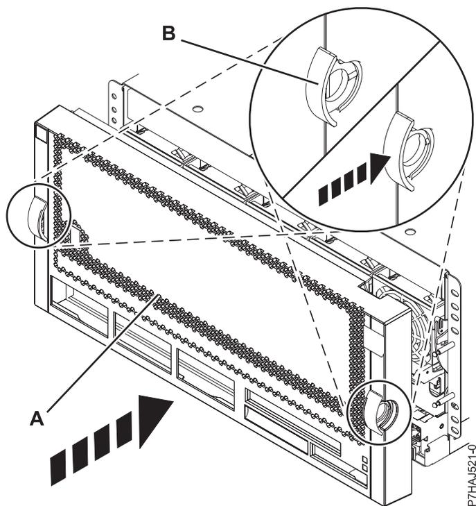
Figura 6. Instalar la cubierta frontal
