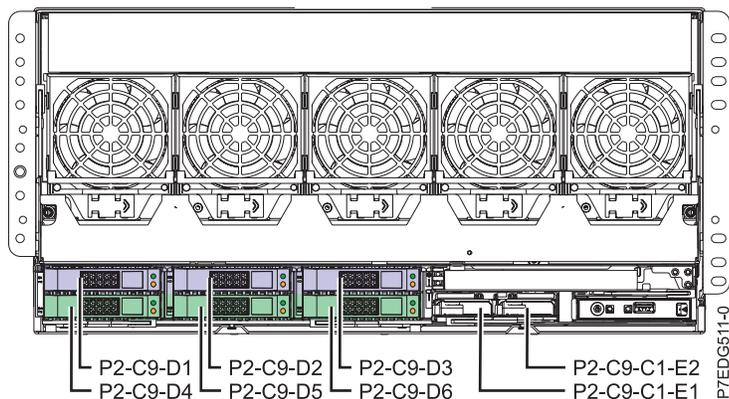
Figura 10. Bahías de disco controladas por cada adaptador SAS incorporado en una placa posterior dividida en dos vías
