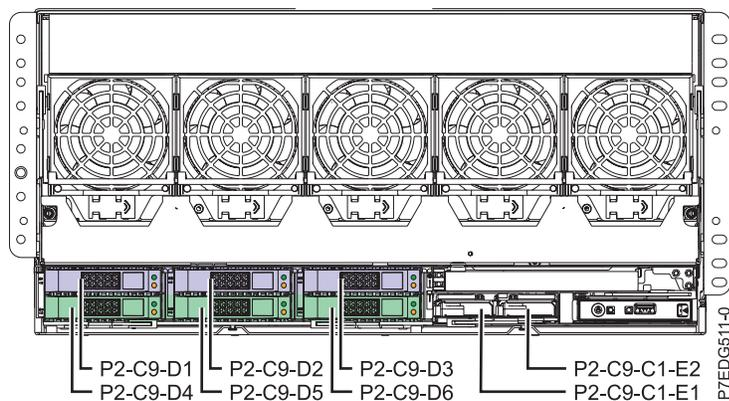
Figura 8. Bahías de disco controladas por cada adaptador SAS incorporado en una placa posterior dividida en dos vías
