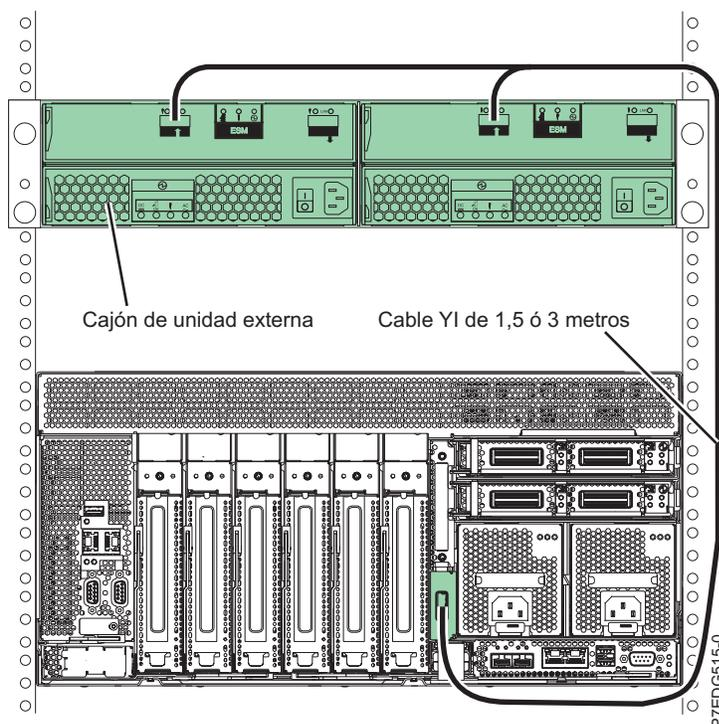
Figura 7. Conexión física para conectar alojamientos de discos externos
