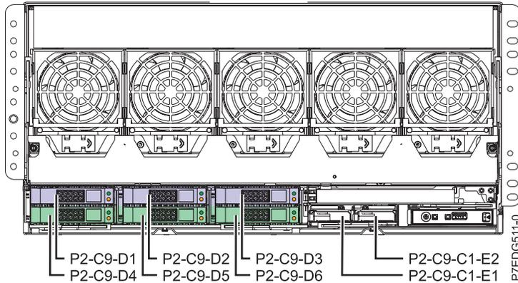
Figura 2. Bahías de disco controladas por cada adaptador SAS incorporado en una placa posterior dividida en dos vías
