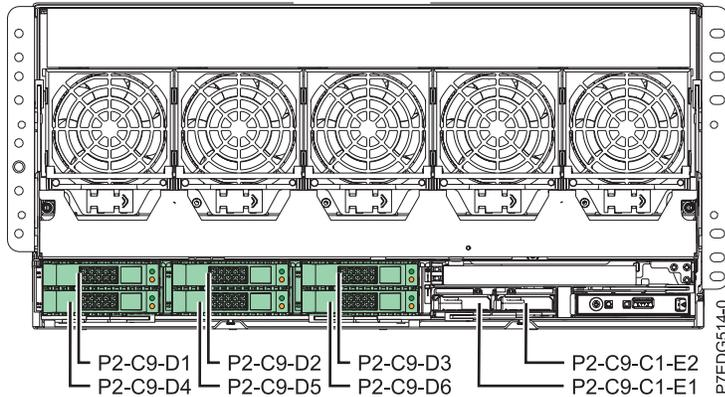
Figura 11. Bahías de disco controladas por los dos adaptadores SAS incorporados que tienen IOA de almacenamiento dual con unidades internas
