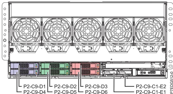
Figura 3. Bahías de disco controladas por cada adaptador SAS incorporado en una placa posterior dividida en tres vías
