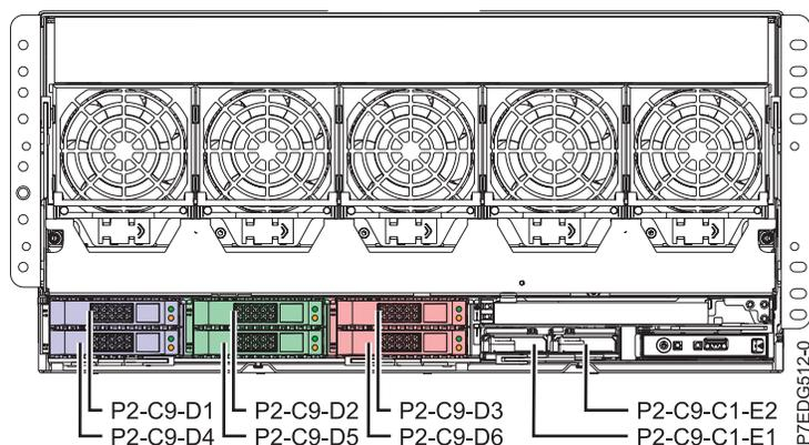
Figura 9. Bahías de disco controladas por adaptadores en una placa posterior dividida en tres vías
