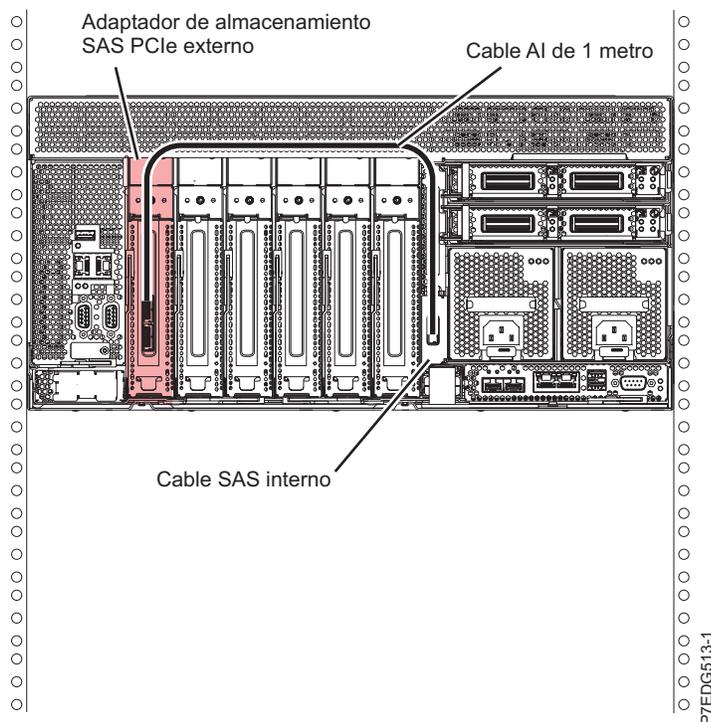
Figura 4. Conexión física a adaptador SAS interno
