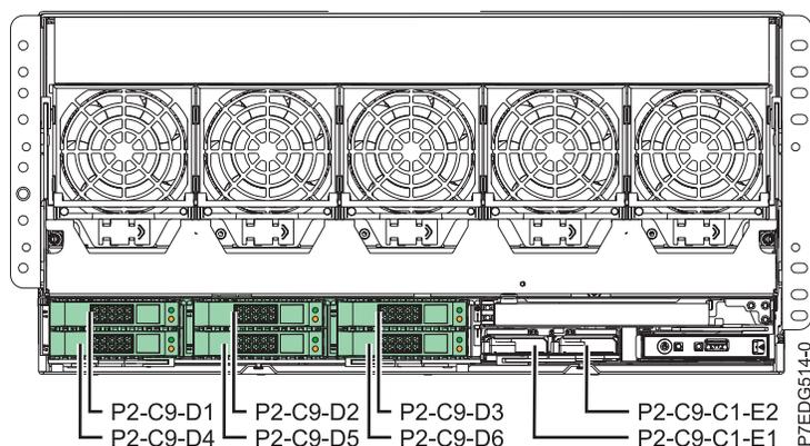
Figura 6. Bahías de disco controladas por los dos adaptadores SAS incorporados que tienen IOA de almacenamiento dual con unidades internas y externas
