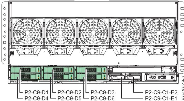
Figura 5. Bahías de disco controladas por los dos adaptadores SAS incorporados que tienen IOA de almacenamiento dual con unidades internas
