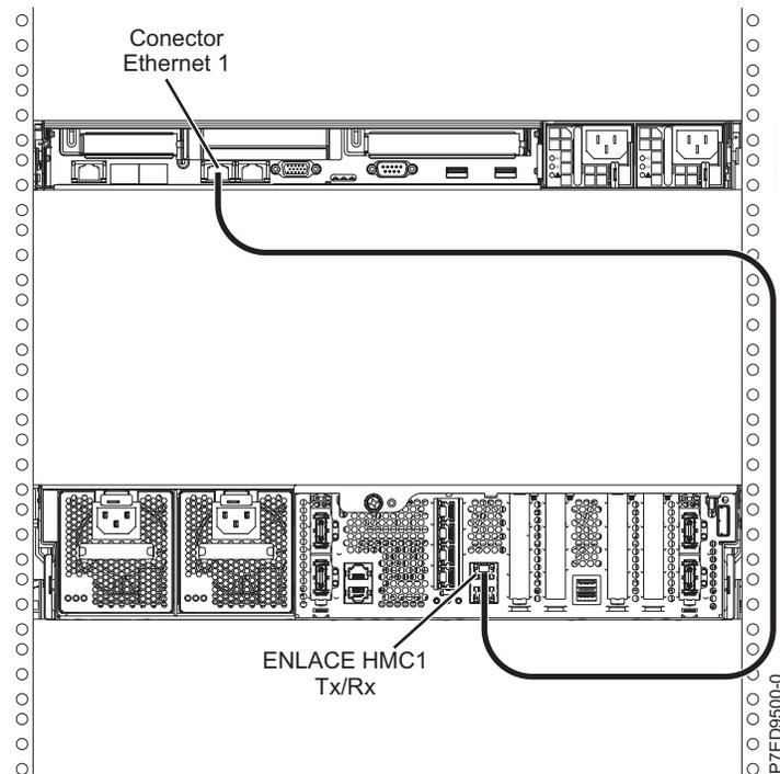
Figura 19. Instalación de la HMC al sistema gestionado
