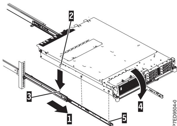
Figura 8. Tendido de los rieles deslizantes y alineación de las cabezas de clavo del servidor con las ranuras del riel
