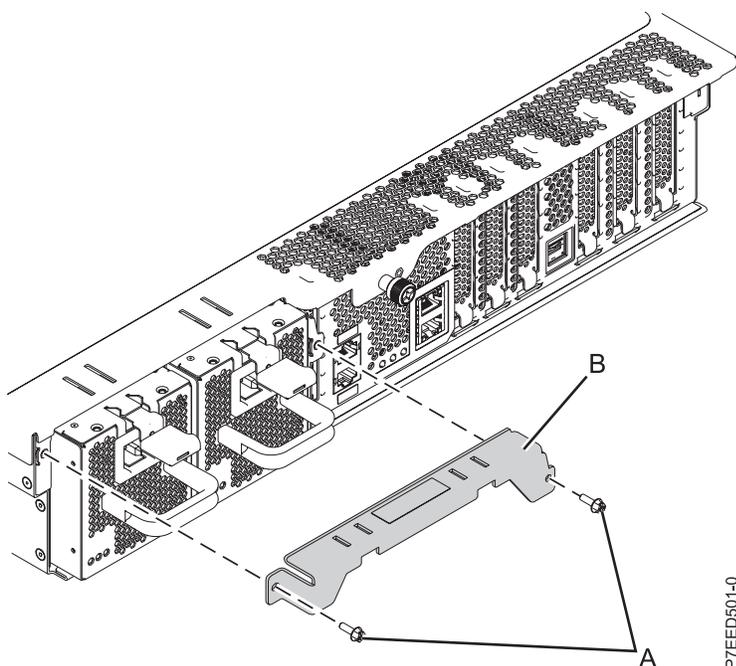
Figura 10. Extracción de la abrazadera de envío
