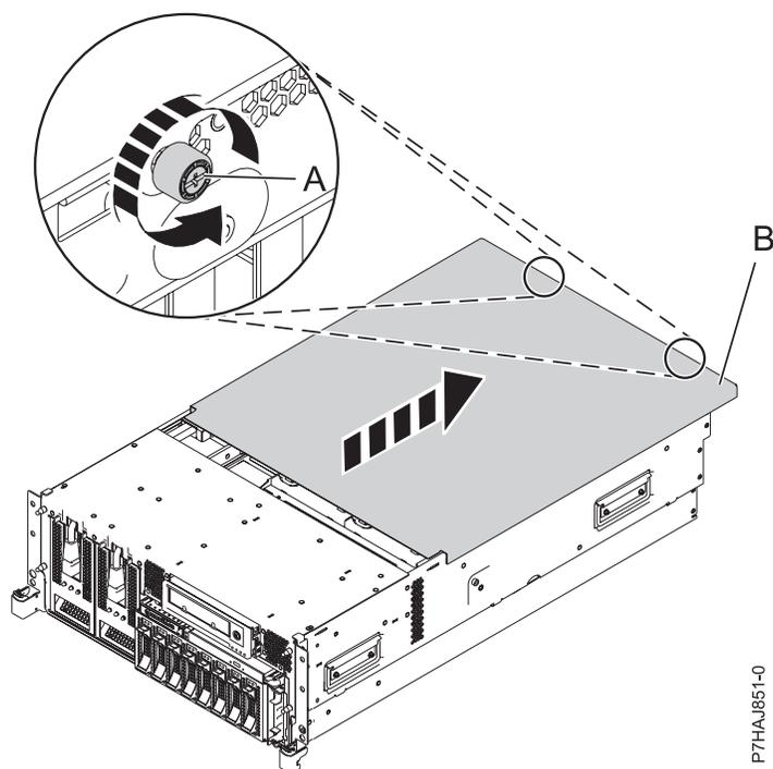
Figura 4. Extraer la cubierta de acceso de servicio
