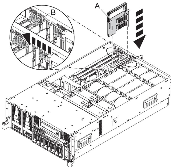
Figura 2. Instalar el Adaptador Ethernet de sistema principal en un modelo montado en bastidor para 8233-E8B o 8236-E8C
