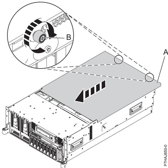
Figura 5. Instalación de la cubierta de acceso de servicio
