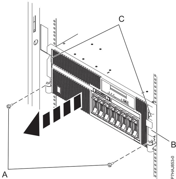
Figura 6. Extraer la cubierta frontal
