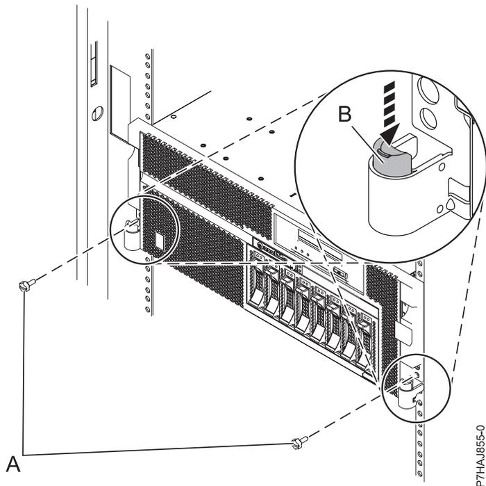
Figura 8. Soltar los pestillos del bastidor
