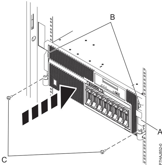
Figura 10. Volver a poner los tornillos de mano
