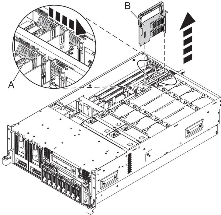
Figura 1. Extracción de un Adaptador Ethernet de sistema principal (P1-C6) para 8233-E8B o 8236-E8C
