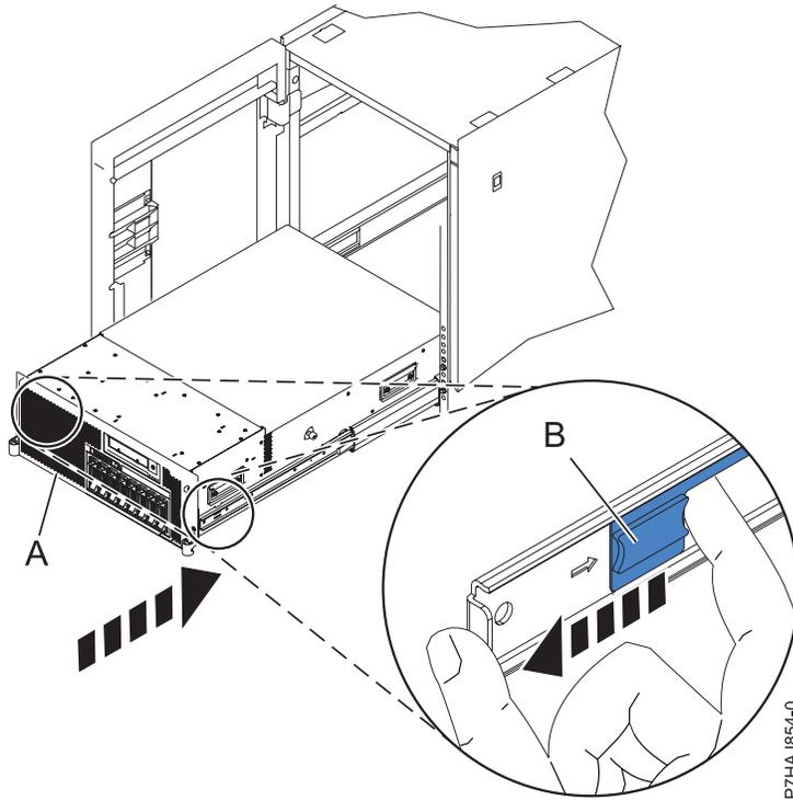
Figura 9. Liberación de los pestillos de seguridad de los rieles
