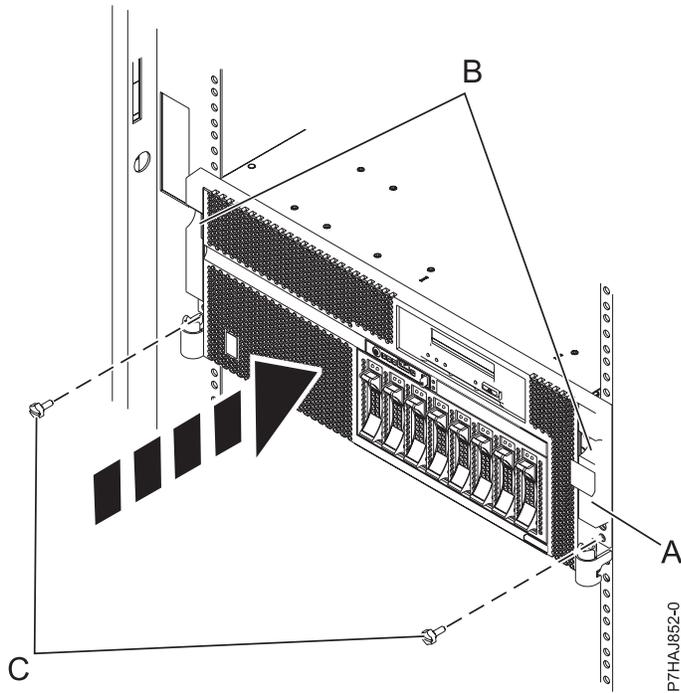
Figura 7. Instalación de la cubierta frontal
