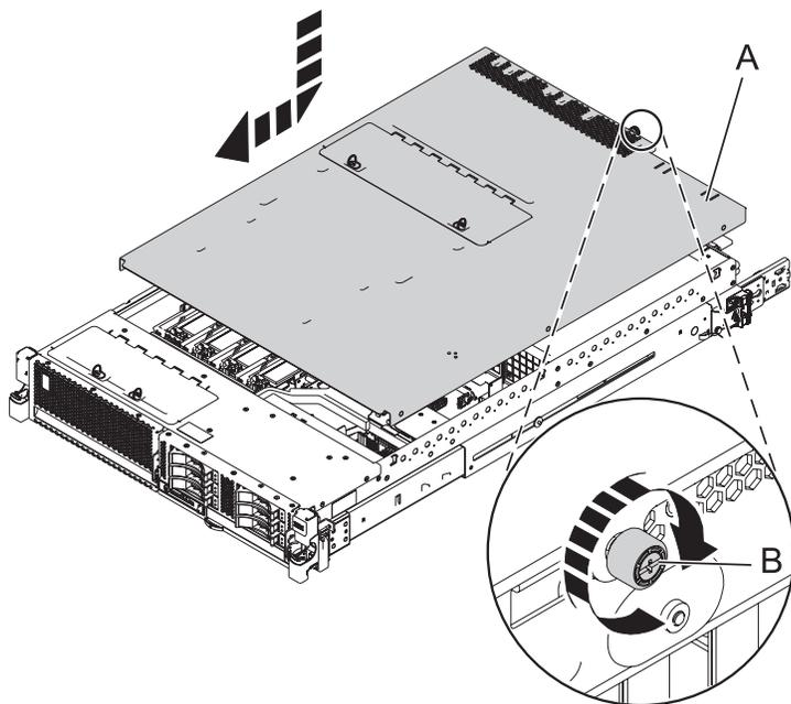
Figura 7. Instalar la cubierta de acceso de servicio
