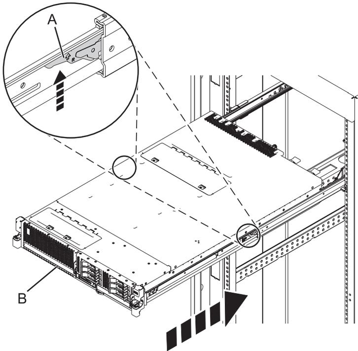
Figura 9. Desbloqueo los pestillos de seguridad de los rieles
