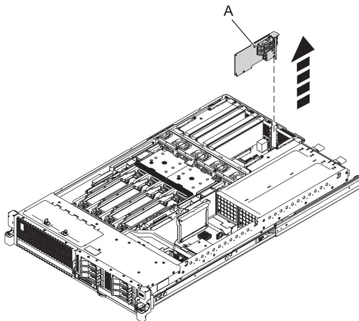
*Figura 1. Extracción de un Adaptador Ethernet de sistema principal (1 GB o 10 GB) para 8231-E2B*
