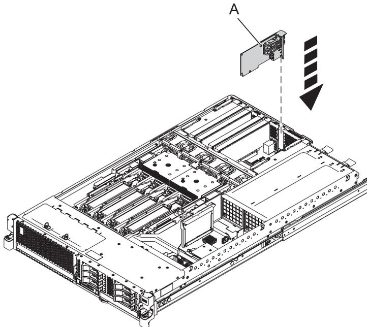
*Figura 2. Instalar el Adaptador Ethernet de sistema principal (1 GB o 10 GB) en un modelo montado en bastidor para 8231-E2B*
