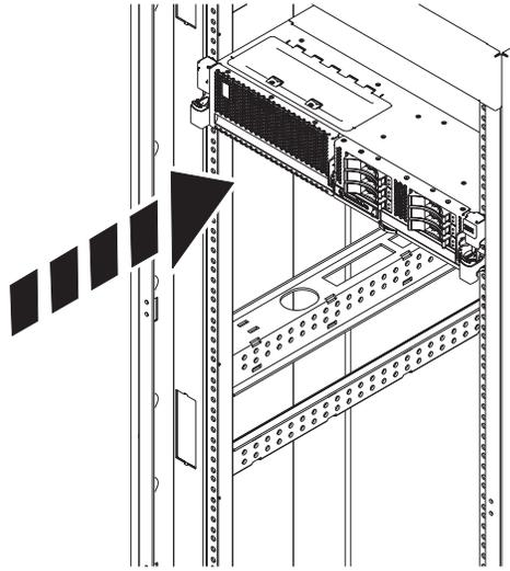
*Figura 10. Colocación del sistema en posición operativa*
