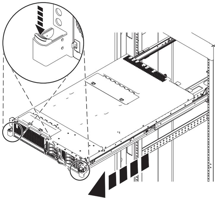
Figura 8. Colocación del sistema en posición de servicio
