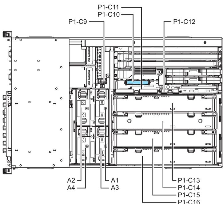
Figura 3. Ubicación de la ranura para la instalación de la tarjeta de memoria caché auxiliar
