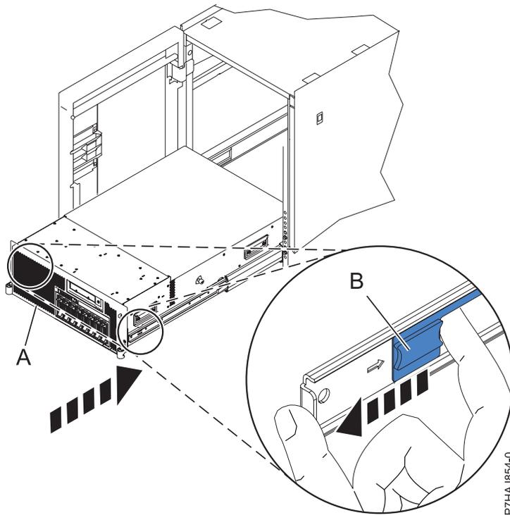
Figura 18. Soltar los pestillos de seguridad de los rieles
