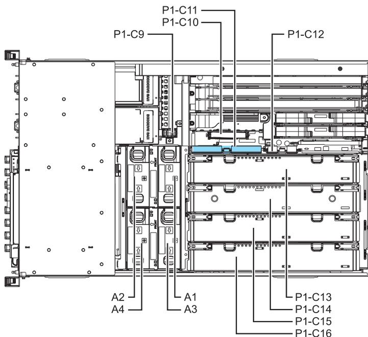
Figura 9. Ubicación de la ranura para la instalación de la tarjeta de habilitación RAID
