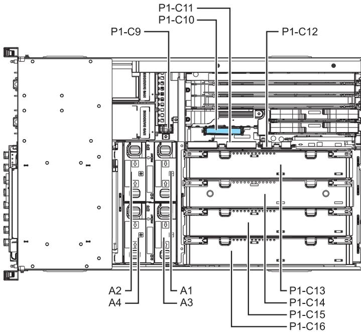
Figura 6. Ubicación de la ranura de la tarjeta de memoria caché auxiliar RAID
