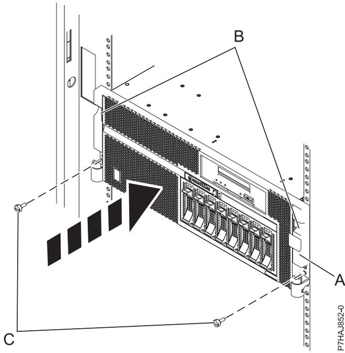
Figura 19. Volver a colocar los tornillos de mano
