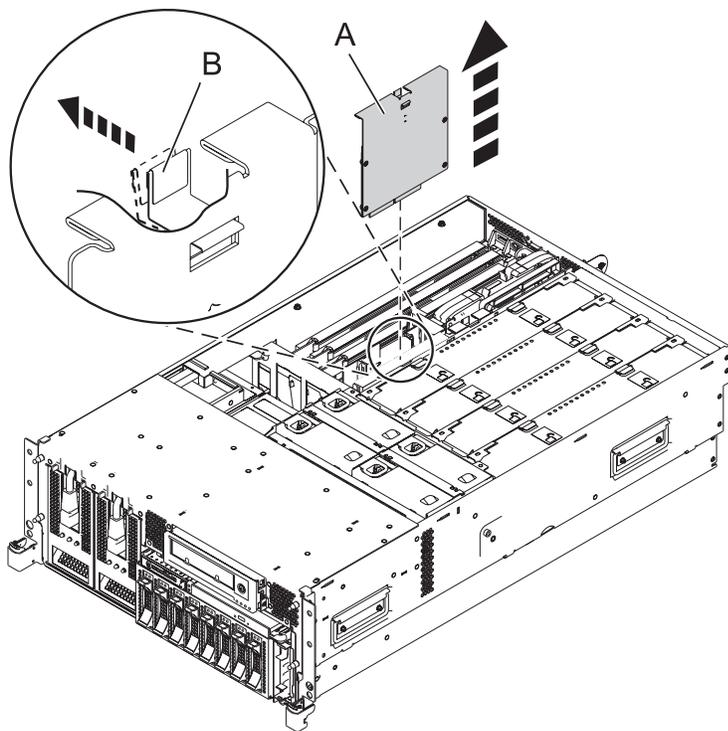
Figura 8. Extraer la tarjeta de habilitación RAID desde una unidad del sistema montada en bastidor
