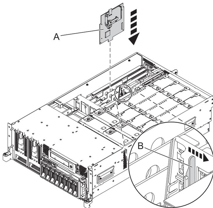
Figura 4. Sustitución de la tarjeta de memoria caché auxiliar RAID de un modelo montado en bastidor
