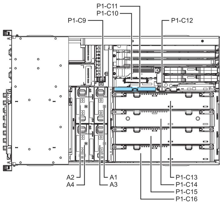
Figura 1. Ubicación de la ranura para la instalación de la tarjeta de habilitación RAID
