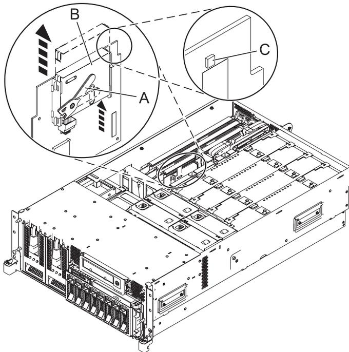
13. Instale la batería de caché de la siguiente manera:
