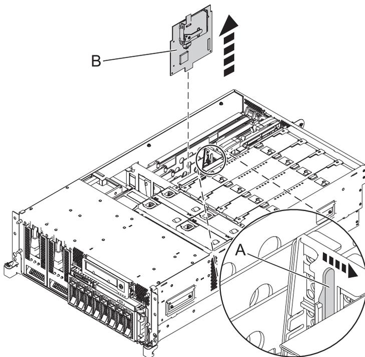
Figura 5. Extraer la tarjeta de memoria caché RAID de una unidad del sistema montada en bastidor
