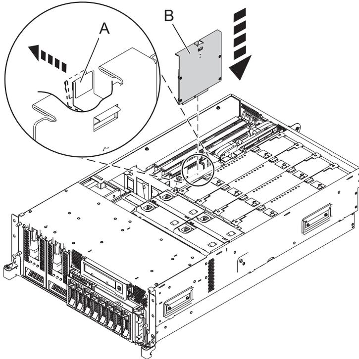
Figura 2. Sustitución de la tarjeta de habilitación RAID de un modelo montado en bastidor
