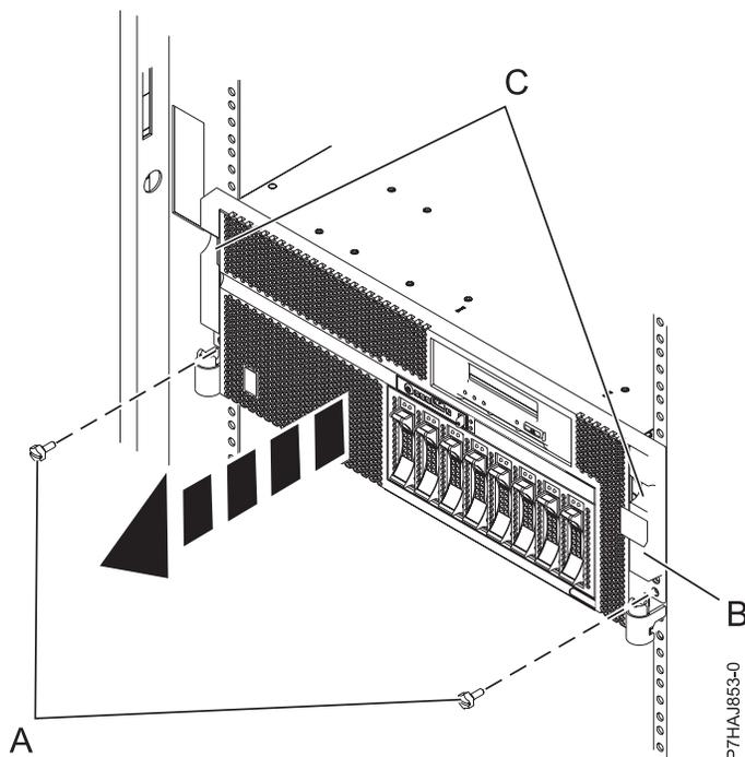
Figura 13. Extraer la cubierta frontal
