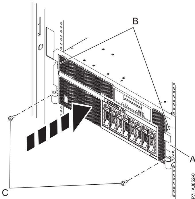
Figura 14. Instalar la cubierta frontal
