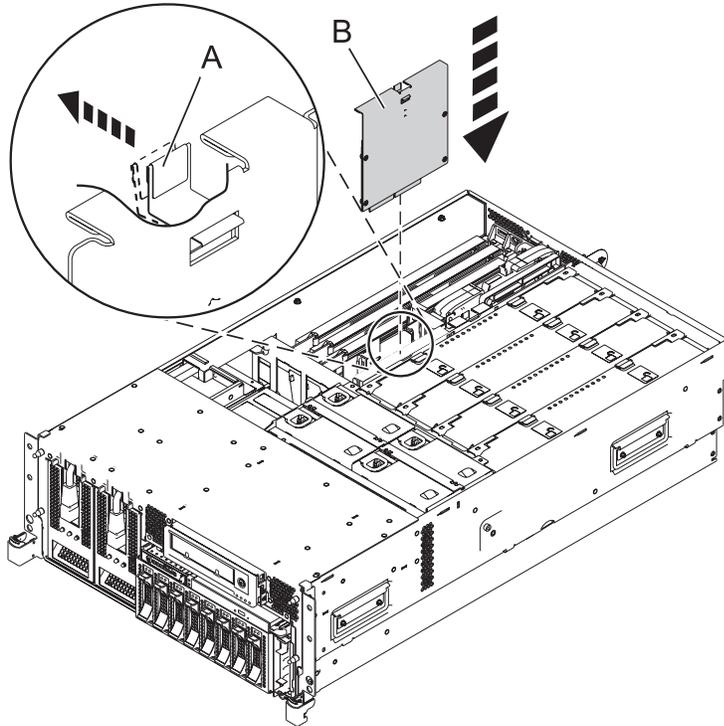
Figura 10. Sustitución de la tarjeta de habilitación RAID en una unidad del sistema montada en bastidor
