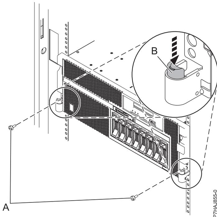
Figura 17. Soltar los pestillos del bastidor
