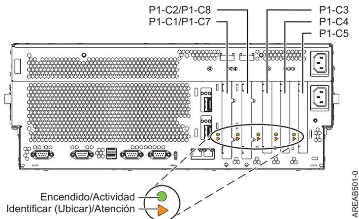
Figura 2. Vista posterior del alojamiento con los códigos de ubicación. Tabla 11 muestra la vista posterior de la unidad de sistema con los códigos de ubicación para las ranuras PCI y GX+.
