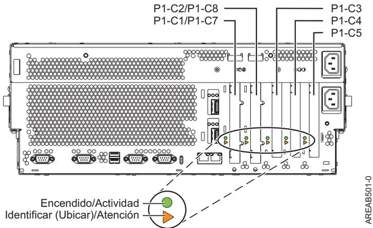
Figura 1. Vista posterior del sistema con los códigos de ubicación. La Tabla 4 muestra la vista posterior del sistema con los códigos de ubicación de las ranuras de adaptador PCI y GX.
