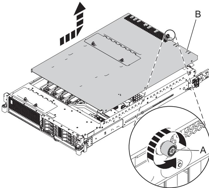
Abbildung 16. Serviceabdeckung ausbauen
