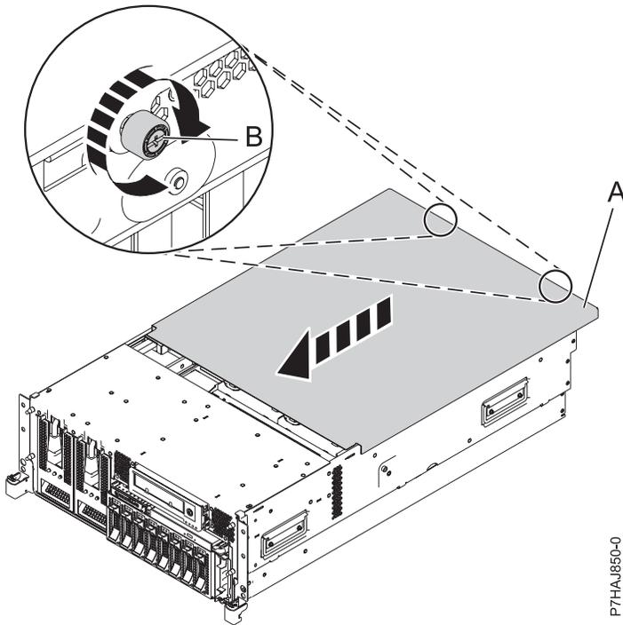
Abbildung 13. Serviceabdeckung installieren
