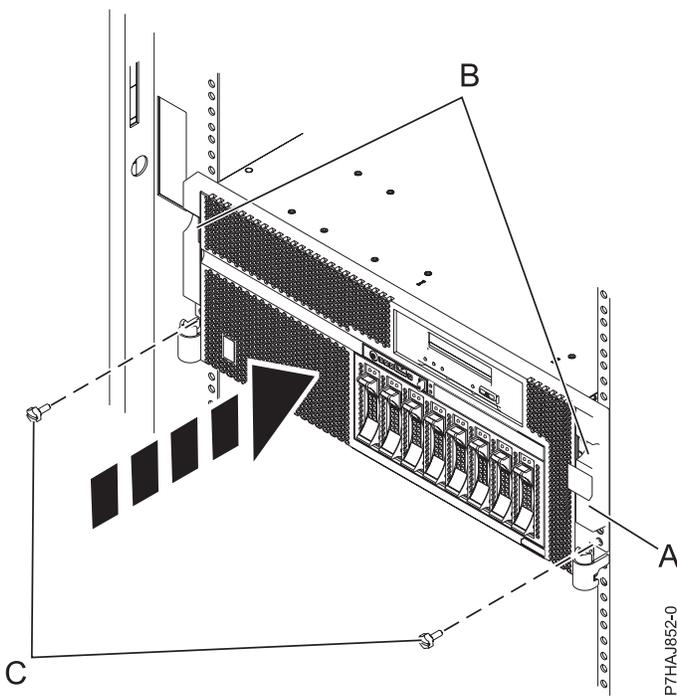
Abbildung 16. Rändelschrauben einsetzen
