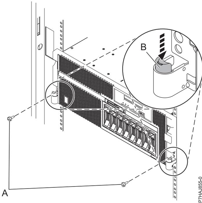
Abbildung 14. Rackverriegelungen entriegeln
