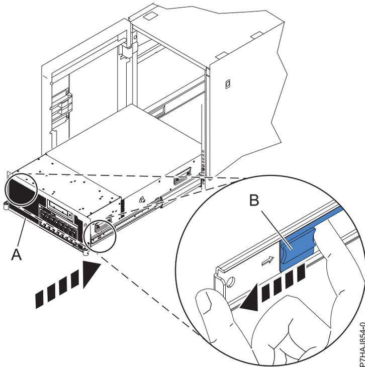
Abbildung 15. Schienensicherheitsverriegelungen entriegeln
