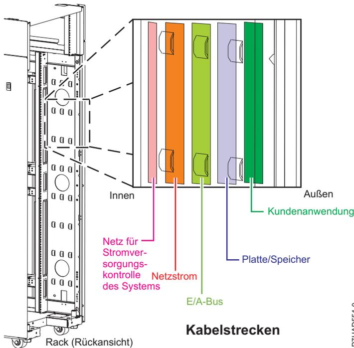
Abbildung 22. Kanäle der Kabelbrücke
