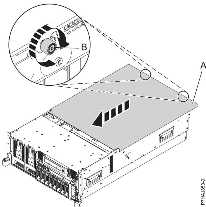
Abbildung 3. Serviceabdeckung installieren
