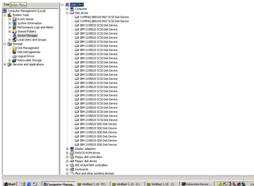
図6. Windows 2000 ホスト・システム上の正常な SDD インストールにおける、ホストに接続された ESS 装置と ESS 装置へのパス・アクセスを示す例
