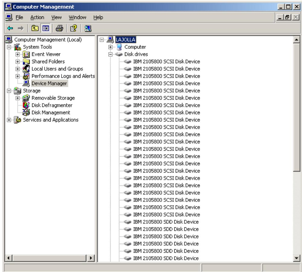
図7. Windows Server 2003 ホスト・システム上の正常な SDD インストールにおける、ホストに接続された ESS 装置と ESS 装置へのパス・アクセスを示す例
