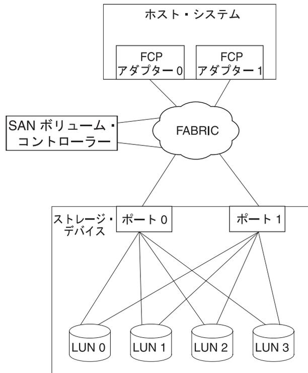
図2. ホスト・システムと SAN ボリューム・コントローラーを備えたディスク装置間のマルチパス接続
