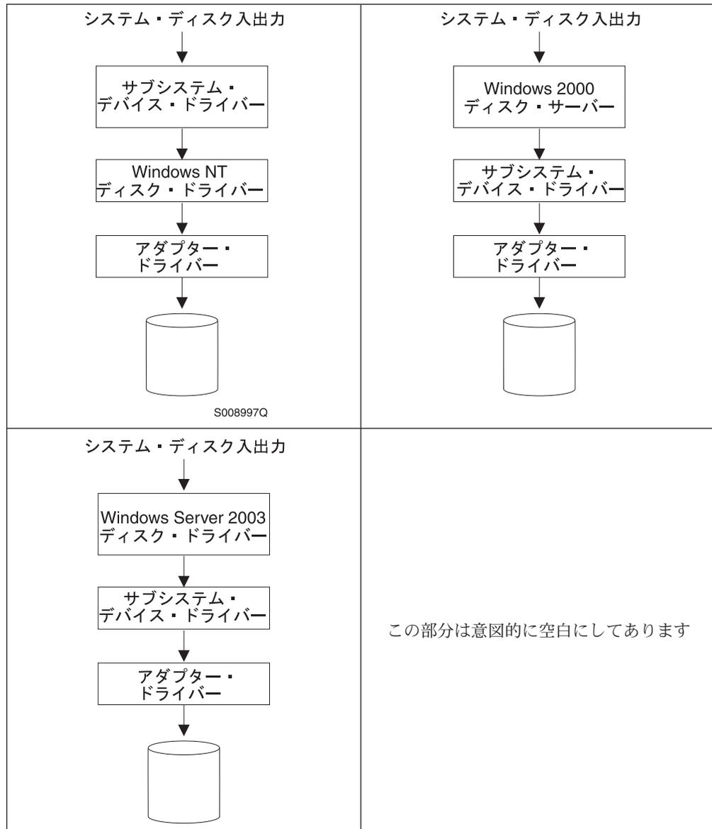
各 SDD vpath 装置は、ストレージ・サーバー上の固有の物理装置を表します。各物理装置は、オペレーティング・システムに対してオペレーティング・システムのディスク装置として提示されます。同じ物理装置への最大 32 個の異なるパスを表す最大 32 個のオペレーティング・システム・ディスク装置を存在させることができます。
