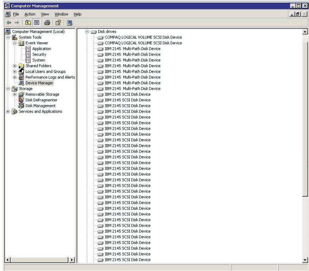
図 8. Windows Server 2003 ホスト・システム上の正常な SDDDSM インストールにおける、ホストに接続された IBM SAN ボリューム・コントローラーと IBM SAN ボリューム・コントローラーへのパス・アクセスを示す例
