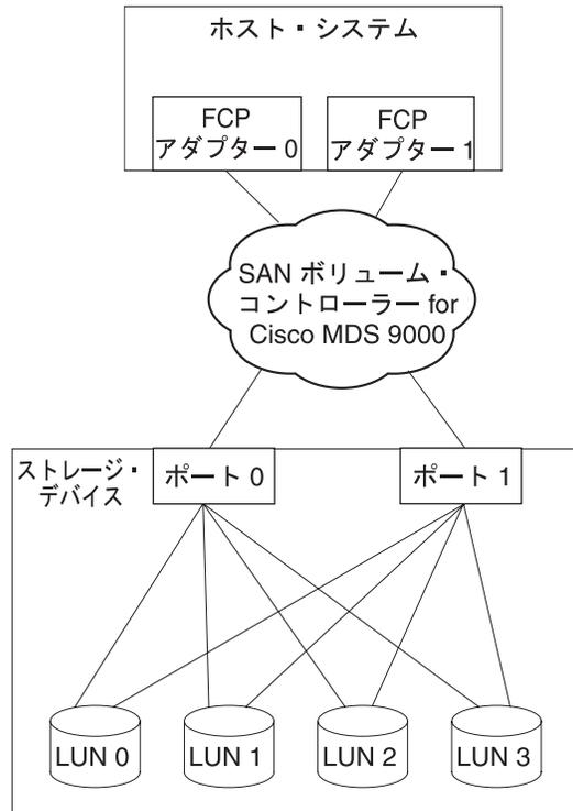
図3. ホスト・システムと、SAN ボリューム・コントローラー for Cisco MDS 9000 を備えたディスク装置間のマルチパス接続
