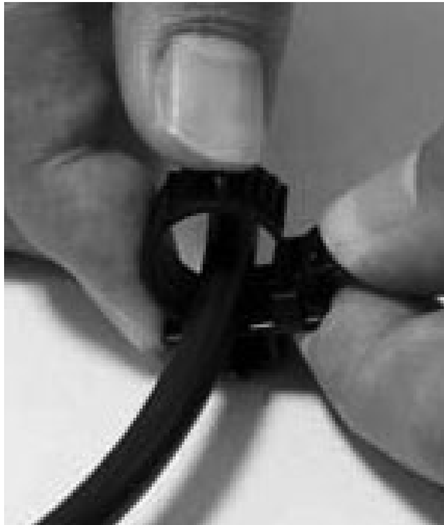
図 15. ケーブル保持ブラケットのアンロック
