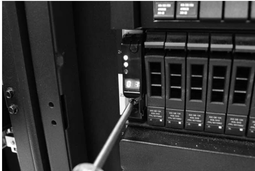
Abbildung 11. Gehäuse in Rackschrank sichern
