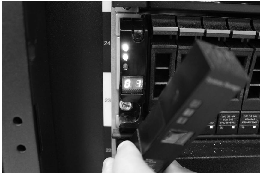
Figura 10. Removendo a Tampa da Extremidade do Gabinete
