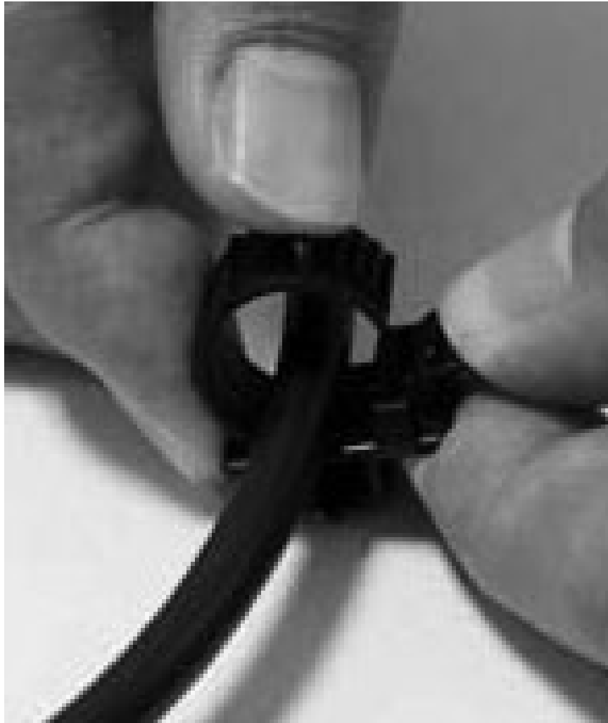
Figura 15. Destravando o Suporte de Retenção de Cabos
