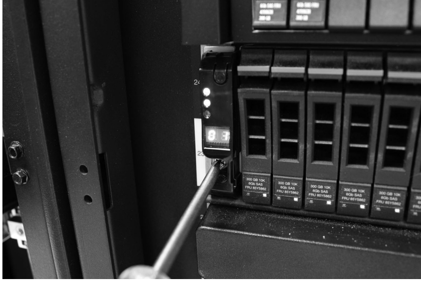
Şekil 14. Kasanın raf kabinine sabitlenmesi
