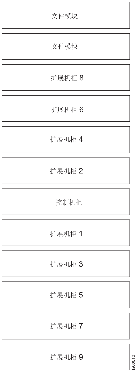
图 10. 建议的机架位置
