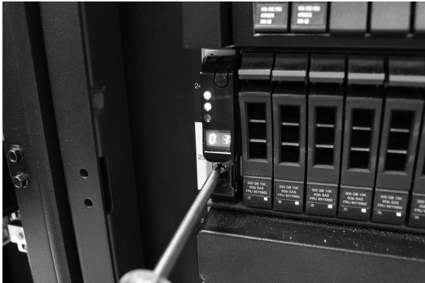
图 14. 将机柜固定到机架式机箱上
