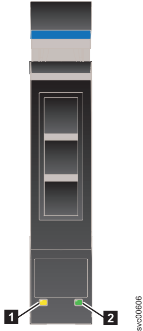
그림 4. 단일 2.5" 드라이브의 LED 표시기
