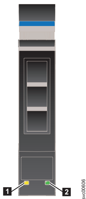
Figura 4. Indicadores de LED em uma Única Unidade de 2,5"
