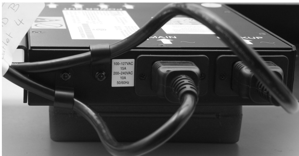
Figura 5. Presilhas do Cabo de Energia
