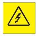
危険な電力が存在します。危険な電力を有する電圧は、金属とショートすると高熱 を発し、結果として金属の飛散、火傷あるいはその両方の原因となる場合がありま す。 (L005)
