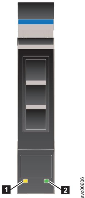
図4. 単一の 2.5 型ドライブの LED インディケータ
