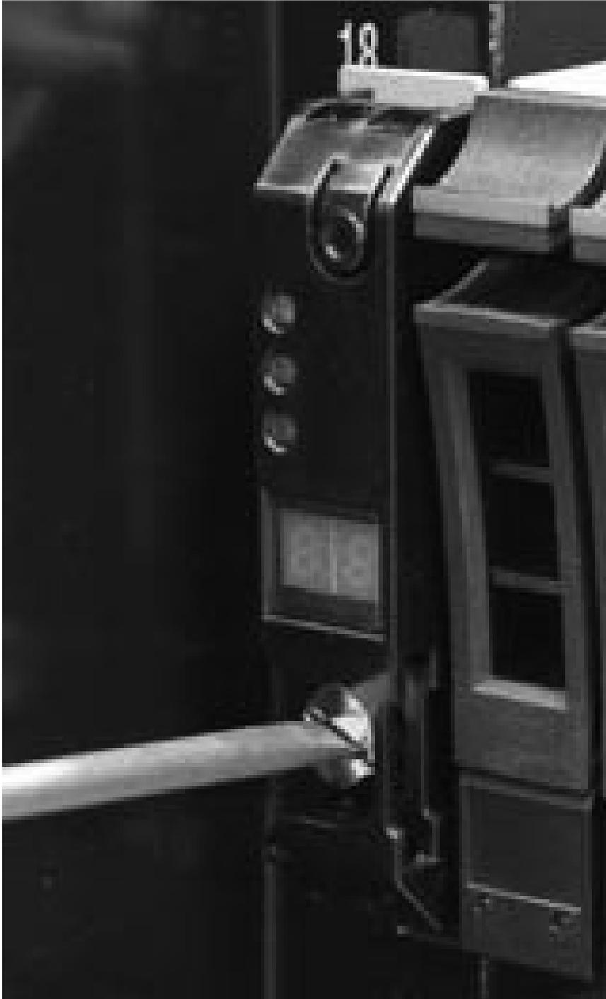
Figure 11. Fixation d'un boîtier dans une armoire
