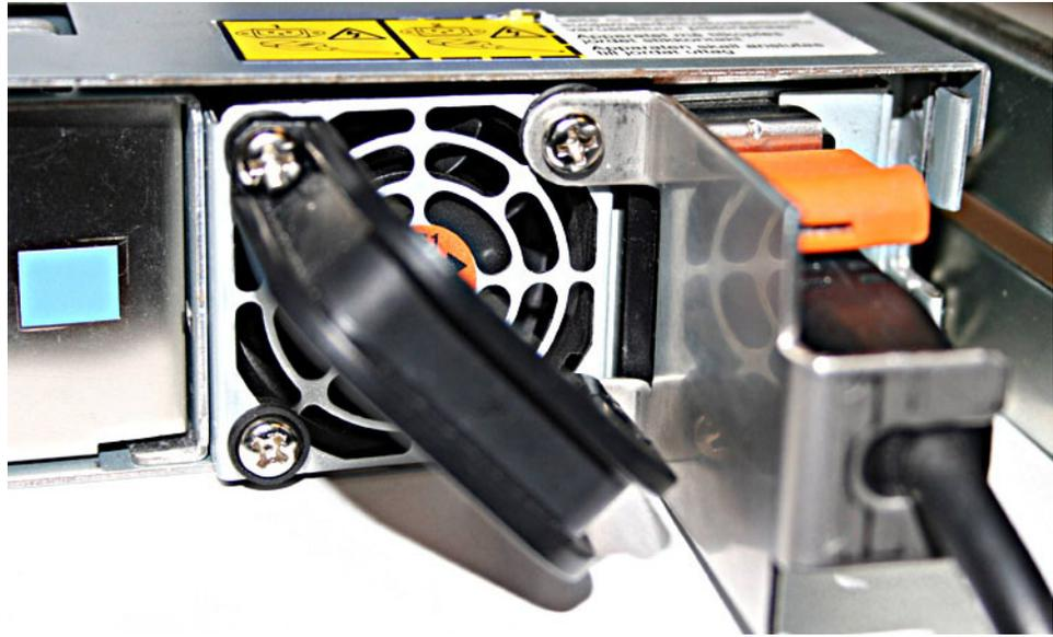
図 26. ケーブル保持ブラケットが取り付けられている SAN ボリューム・コントローラー 2145-8G4
