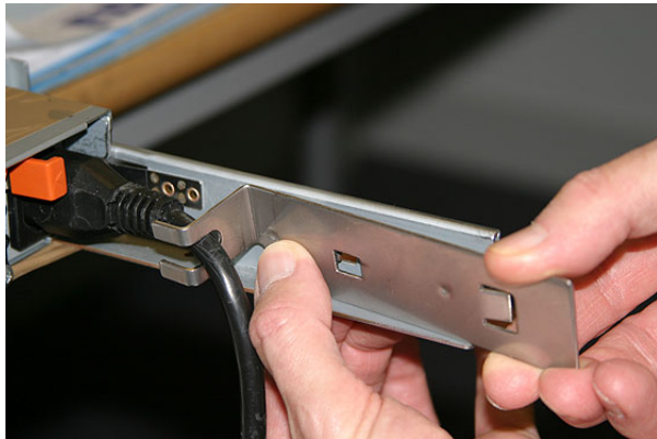
図 44. SAN ボリューム・コントローラー 2145-8F4 電源ケーブルへのケーブル保持ブラケットの取り付け
