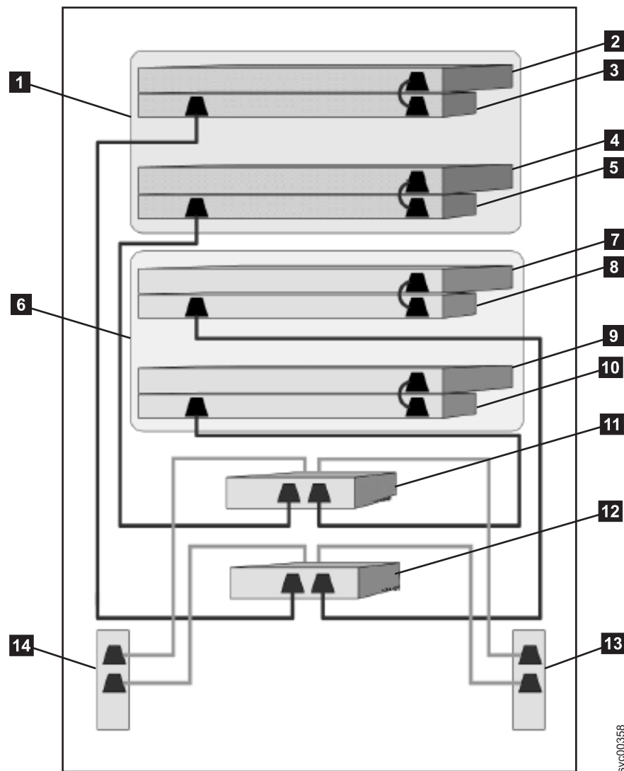
図 16. 冗長 AC 電源スイッチ クラスターを持つ、4-ノード SAN ボリューム・コントローラー クラスター
