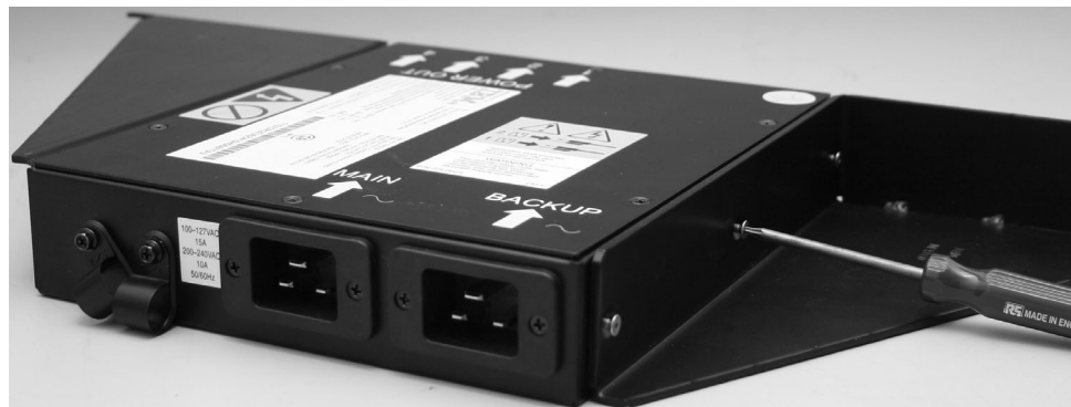
図 11. 取り付けプレートの取り付け
