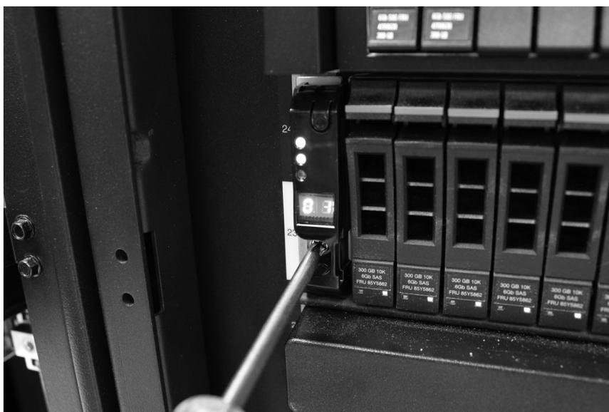
Figure 13. Fixation d'un boîtier à une armoire
