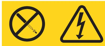
Présence de tensions, de courants et de niveaux d'énergie dangereux dans tout composant sur lequel cette étiquette est apposée. Aucune pièce de ces composants n'est réparable. Si vous pensez qu'ils peuvent être à l'origine d'un incident, contactez un technicien de maintenance.
