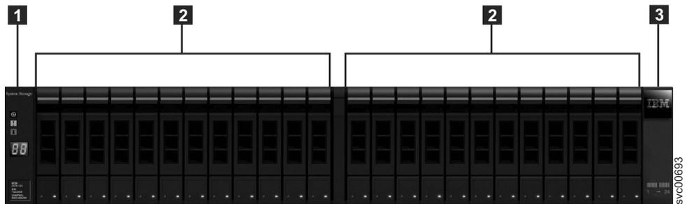
Figure 2. Cette figure présente 24 unités et deux caches d'extrémité (modèle 2076-124).
