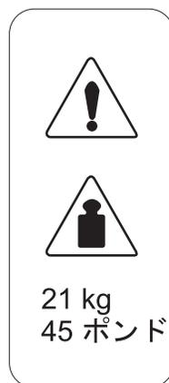
図 14. 無停電電源装置のバッテリー装置上の重量ラベル
