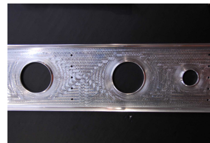
加工例: 板厚Min=0.68mm
