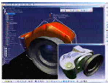
サーフェスを自由にタッチできる クレイモデリングを実現
