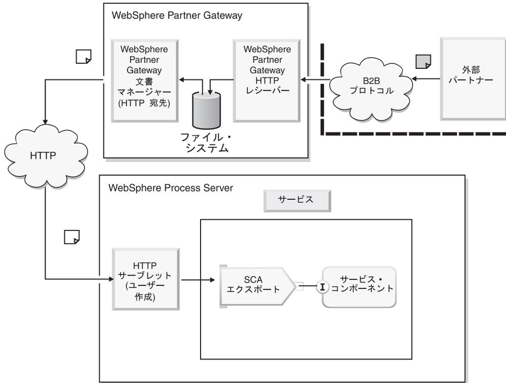
図 21. WebSphere Partner Gateway からメッセージが HTTP サーブレットに送信される仕組み
