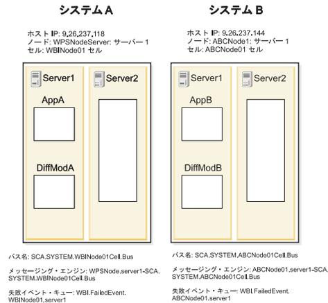
図 55. 別のシステムでサービスを呼び出す
