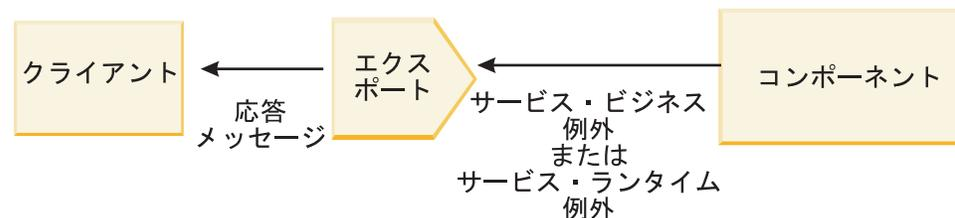
図9. 障害情報をエクスポート・バインディングを経由してコンポーネントからクライアントに送信する方法
