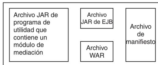
Figura 19. Ejemplo simplificado de un archivo EAR que contiene un módulo de mediación. El archivo EAR contiene varios archivos JAR. El archivo JAR de programa de utilidad contiene un módulo de mediación.
