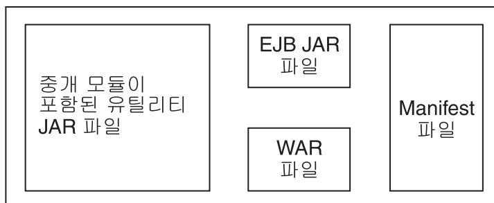
그림 9. 중개 모듈을 포함하는 EAR 파일의 단순화된 예제. EAR 파일에 JAR이 포함됩니다. 유틸리티 JAR 파일에 중개 모듈이 포함됩니다.
