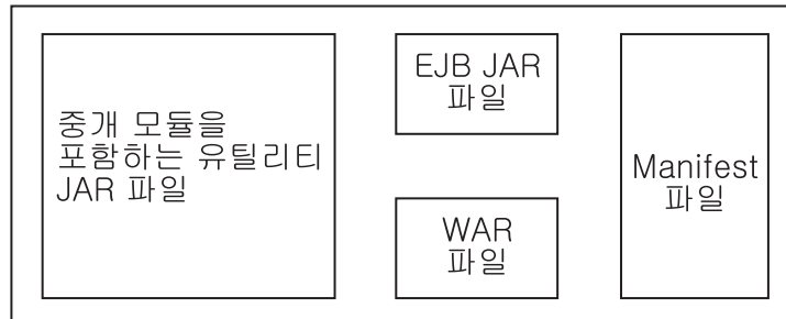
그림 6. 중개 모듈이 포함된 EAR 파일의 단순 예제. EAR 파일에는 JAR이 포함됩니다. 유틸리티 JAR 파일에는 중개 모듈이 포함됩니다.
