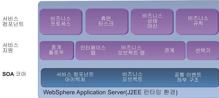
그림 4. WebSphere Process Server 컴포넌트 기반 프레임워크
