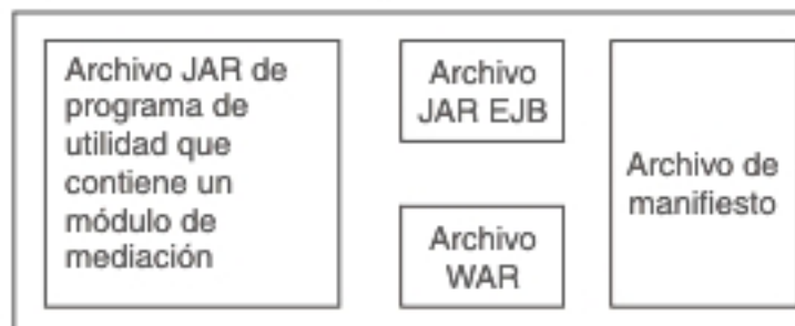
Figura 6. Ejemplo simplificado de un archivo EAR que contiene un módulo de mediación. El archivo EAR contiene unos archivos JAR. El archivo JAR de programa de utilidad contiene un módulo de mediación.
