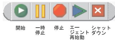
図 24. System Monitor、コンポーネントを開始、一時停止、再始動、またはシャットダウンするアイコン
