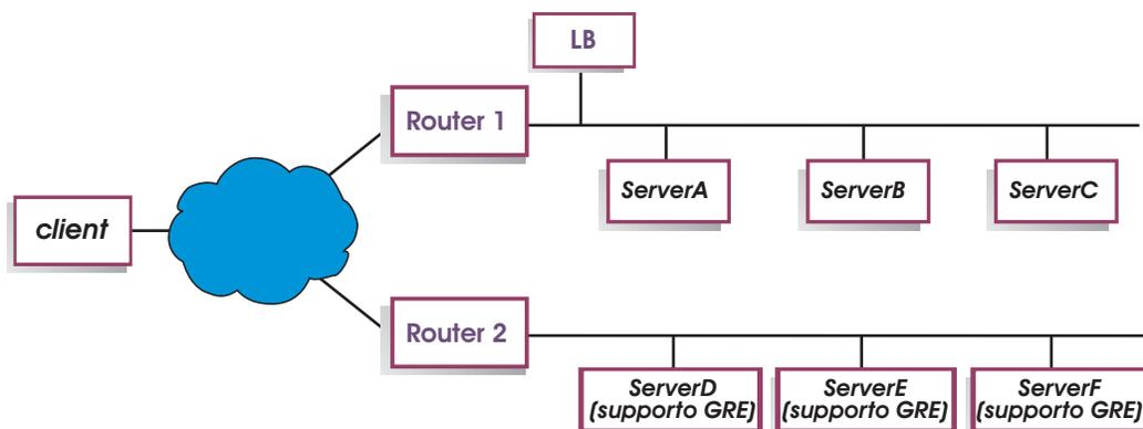
Figura 38. Configurazione di esempio di rete geografica con piattaforma server che supporta GRE
