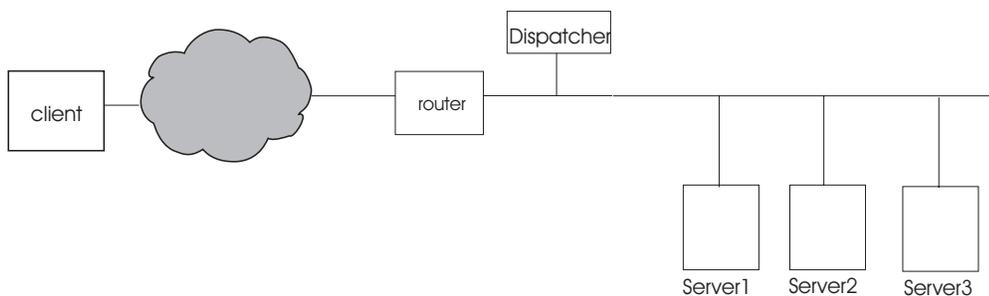
Figura 35. Esempio di una configurazione costituita da un unico segmento LAN
