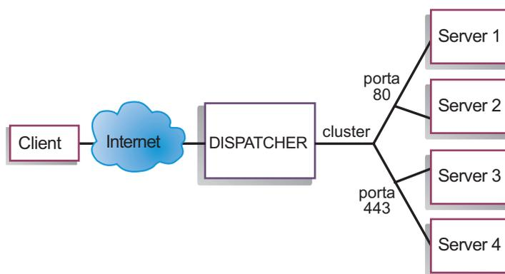
Figura 9. Esempio di Dispatcher configurato con un unico cluster e 2 porte
