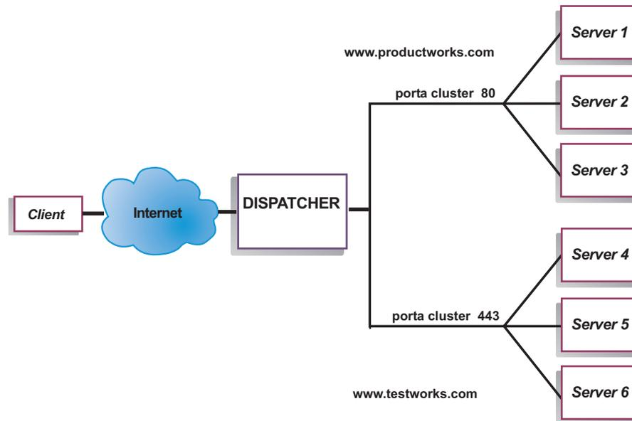
Figura 10. Esempio di Dispatcher configurato con due cluster, ognuno con una porta
