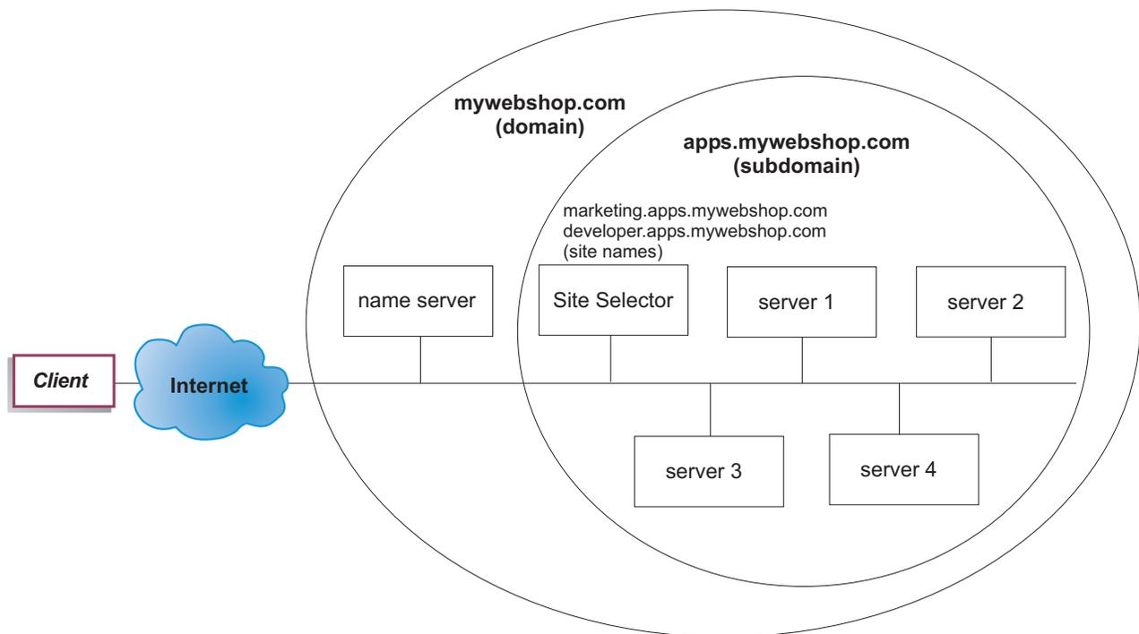
Figura 23. Una configurazione Site Selector semplice
