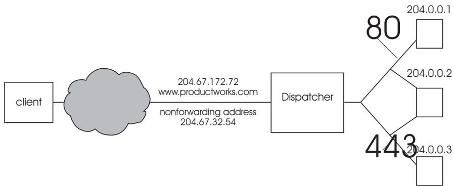
Figura 15. Esempio degli indirizzi IP necessari per la macchina Dispatcher
