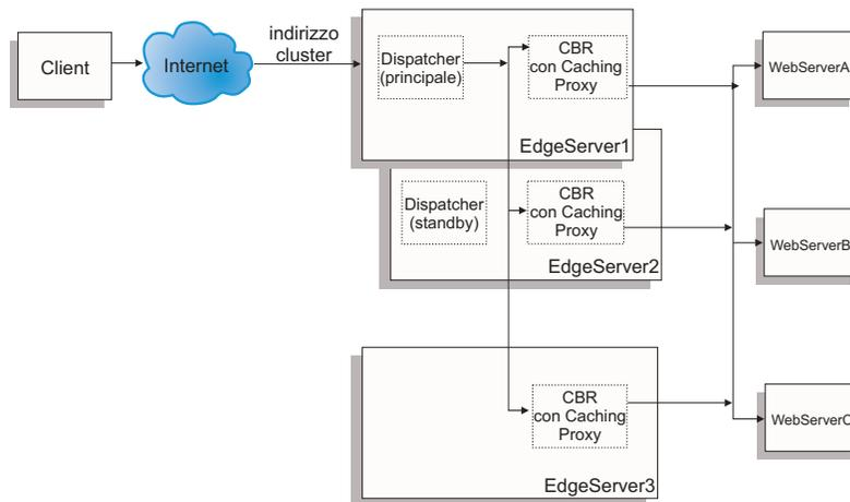
Figura 46. Esempio di configurazione di disponibilità elevata a due livelli con Dispatcher, CBR e Caching Proxy
