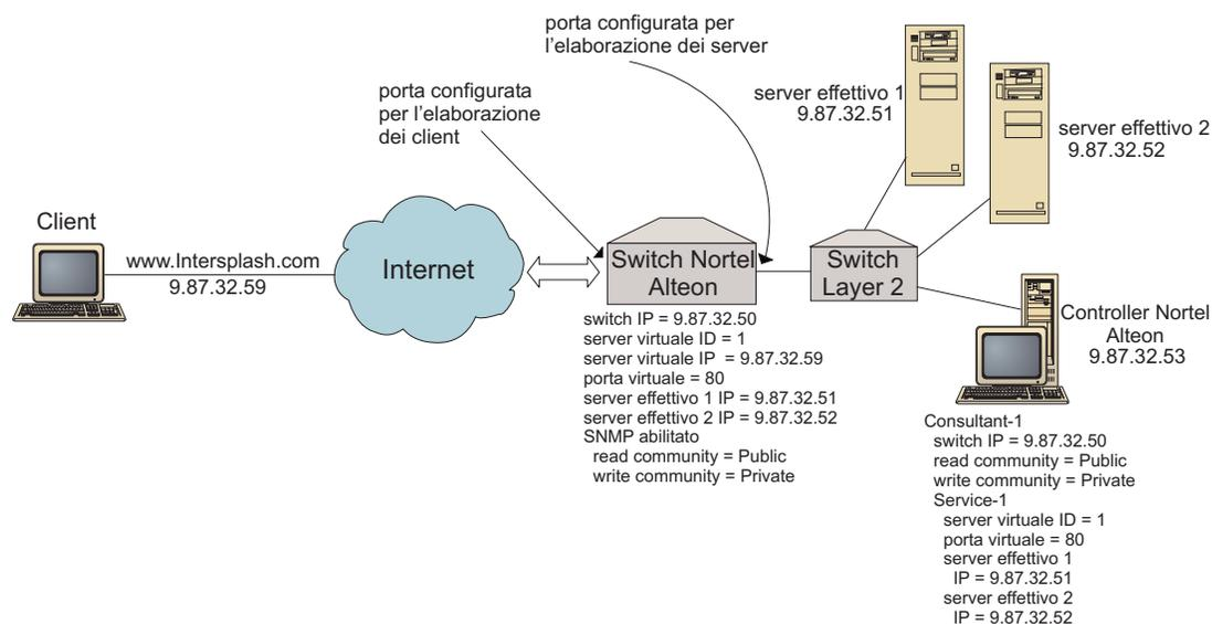
Figura 28. Una configurazione Controller Nortel Alteon semplice
