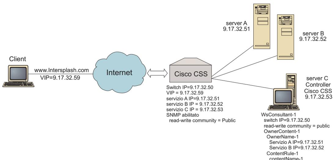
Figura 25. Una configurazione Cisco CSS Controller semplice
